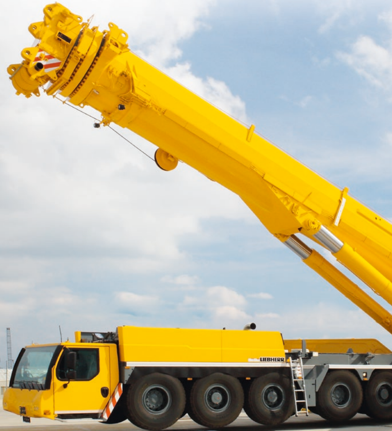
① LTM 1750-9.1 abgestützt auf den vorderen Stützen
