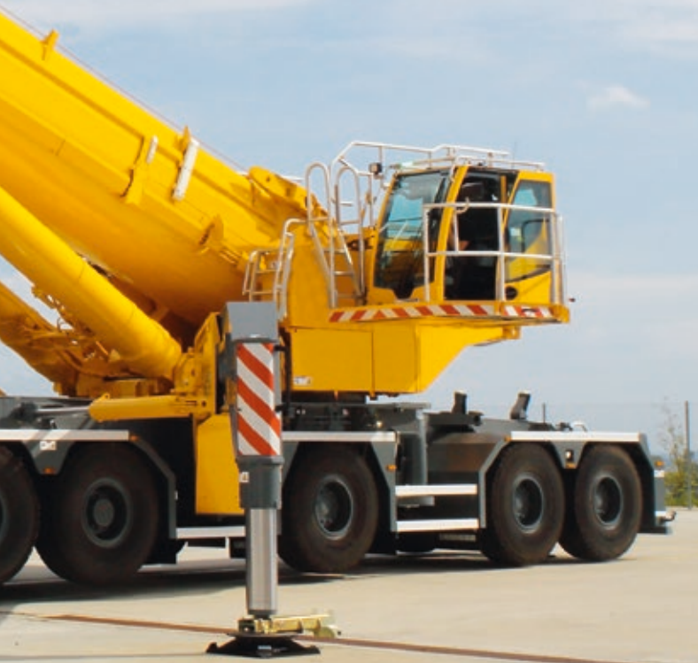
③ Selbstmontage der hinteren Abstützungen
