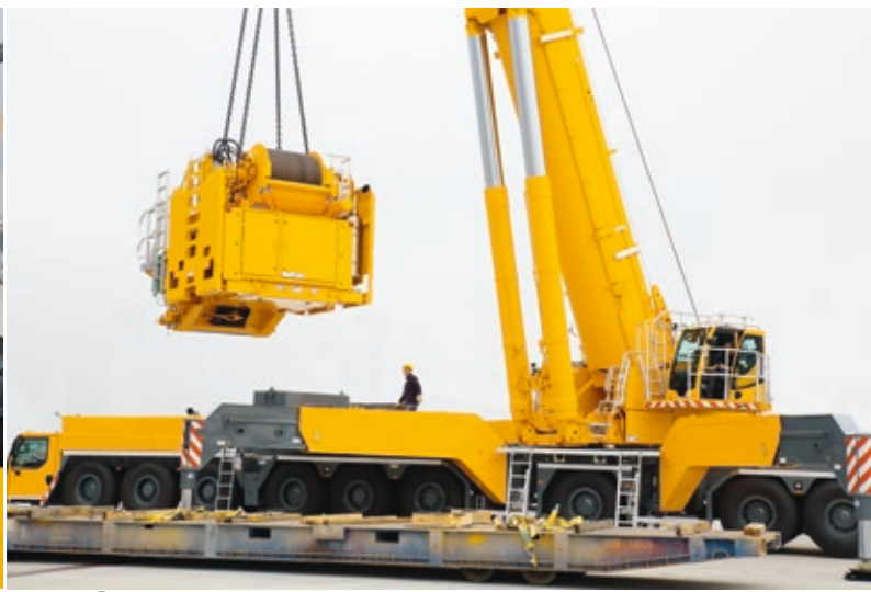
⑥ Selbstmontage Gegengewichtsrahmen mit Antriebsaggregat
