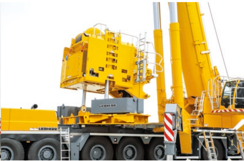
7 Zylinder des Gegengewichtstrahmens auf Ballastgrundplatte fixiert
