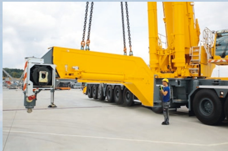
③ Selbstmontage der hinteren Abstützungen
