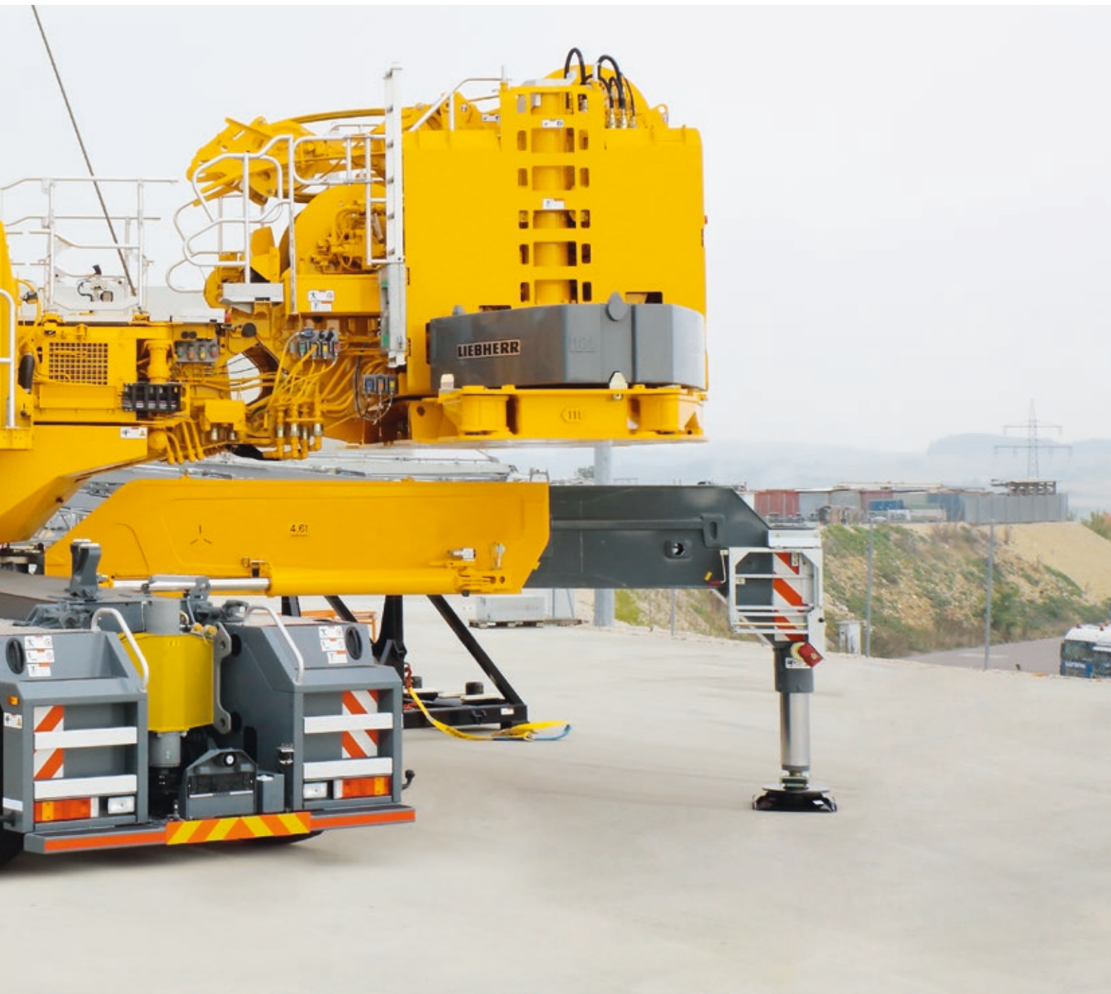
7 Zylinder des Gegengewichtstrahmens auf Ballastgrundplatte fixiert
