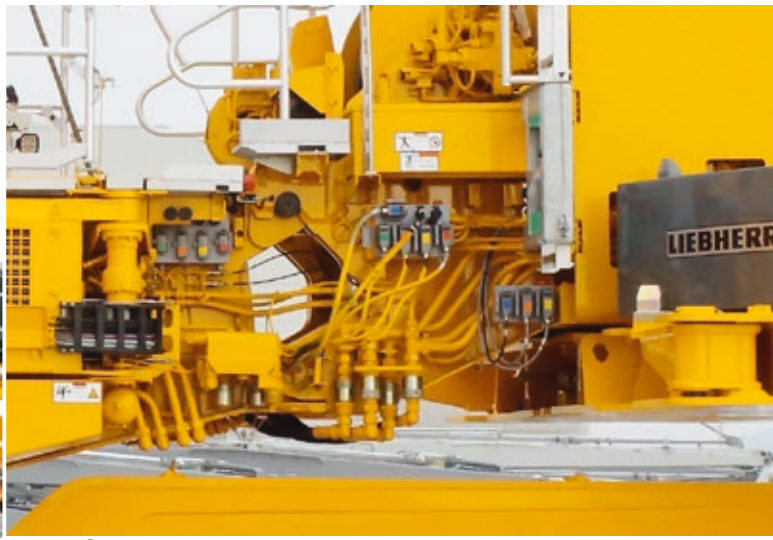
8 Hydraulische und elektrische Schnellkupplungen verbinden
