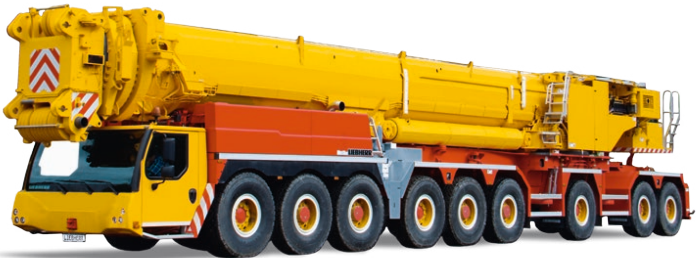
Gesamtgewicht 99 t bei 11 t Achslast ohne Abstützungen
