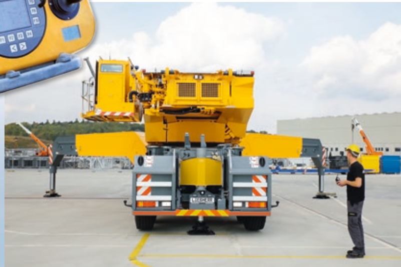
② Zusatzabstützung Fahrzeugheck
