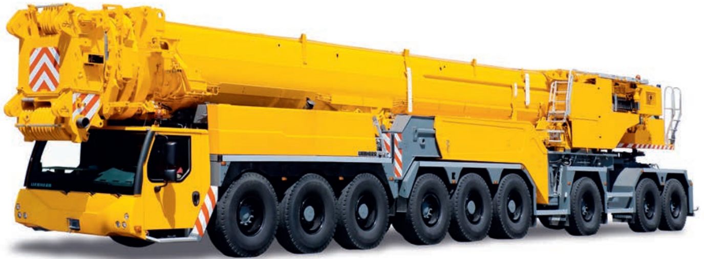
Gesamtgewicht 108 t bei 12 t Achslast mit vorderen Abstützungen
