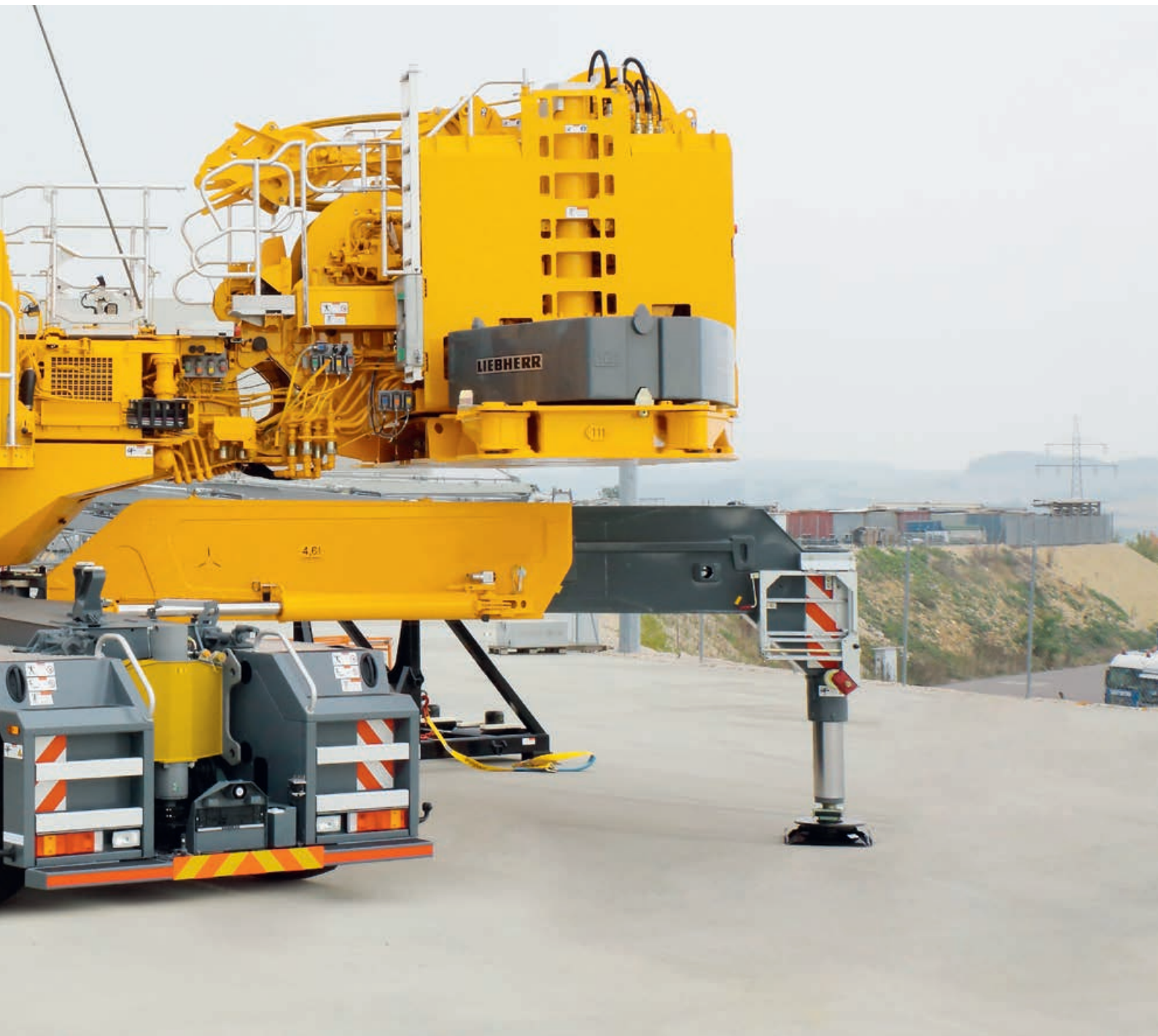
7 Zylinder des Gegengewichtstrahmens auf Ballastgrundplatte fixiert
