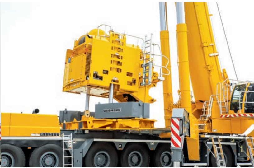
7 Zylinder des Gegengewichtstrahmens auf Ballastgrundplatte fixiert
