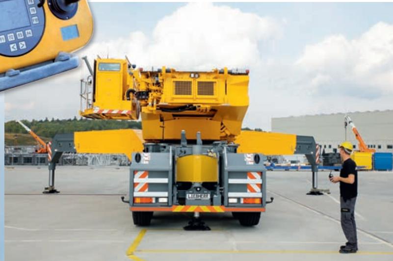
② Zusatzabstützung Fahrzeugheck
