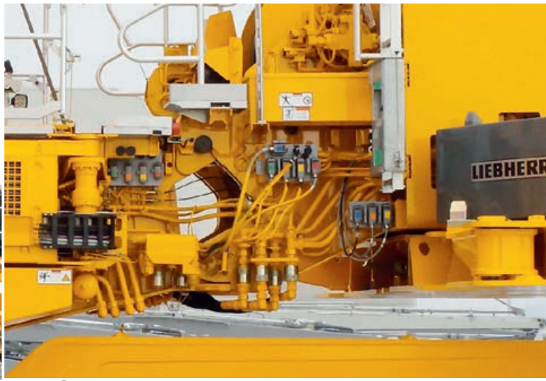
8 Hydraulische und elektrische Schnellkupplungen verbinden
