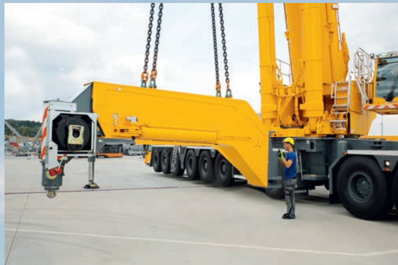
③ Selbstmontage der hinteren Abstützungen
