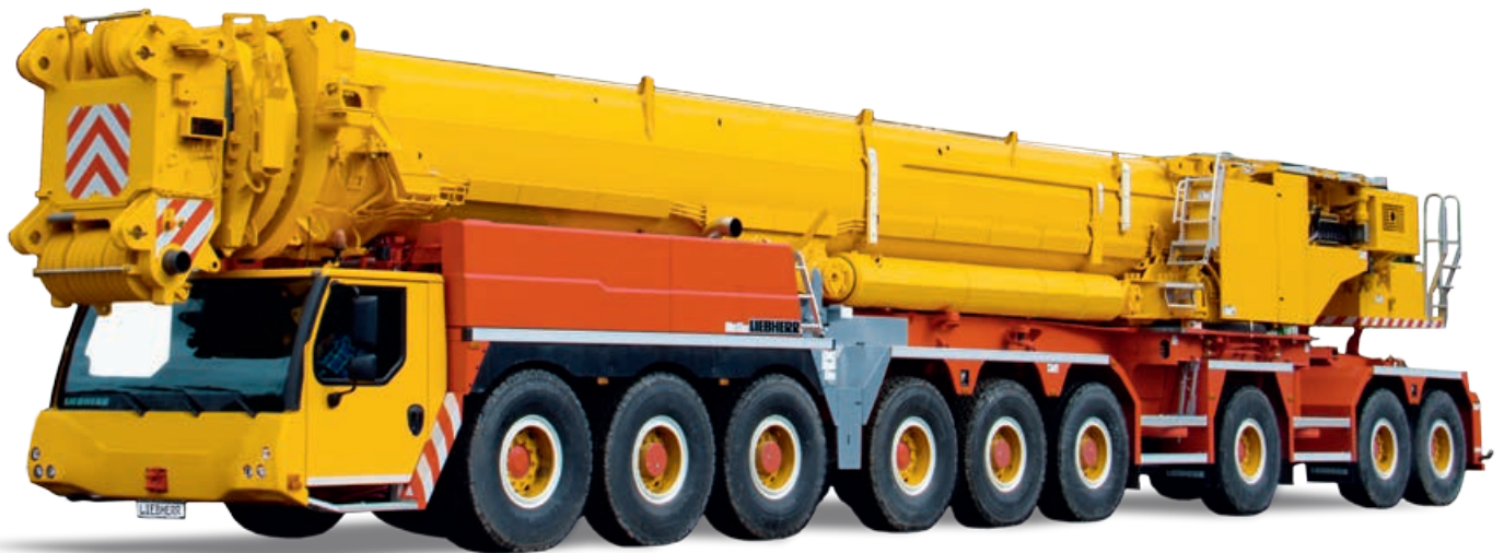
Gesamtgewicht 99 t bei 11 t Achslast ohne Abstützungen
