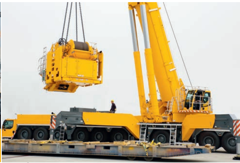
⑥ Selbstmontage Gegengewichtsrahmen mit Antriebsaggregat
