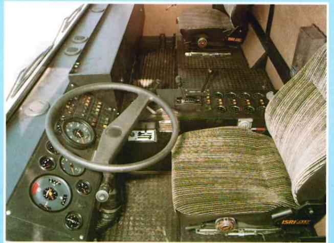
Das Fahrerhaus ist eine gegen Korrosion vollverzinkte und schallisolierte Großraumkabine mit in der Höhe und Neigung verstellbarem Lenkrad, standardisierten Bedien- und Kontrollinstrumenten und hydraulisch gedämpften Komfortsitzen für Fahrer und Beifahrer.
