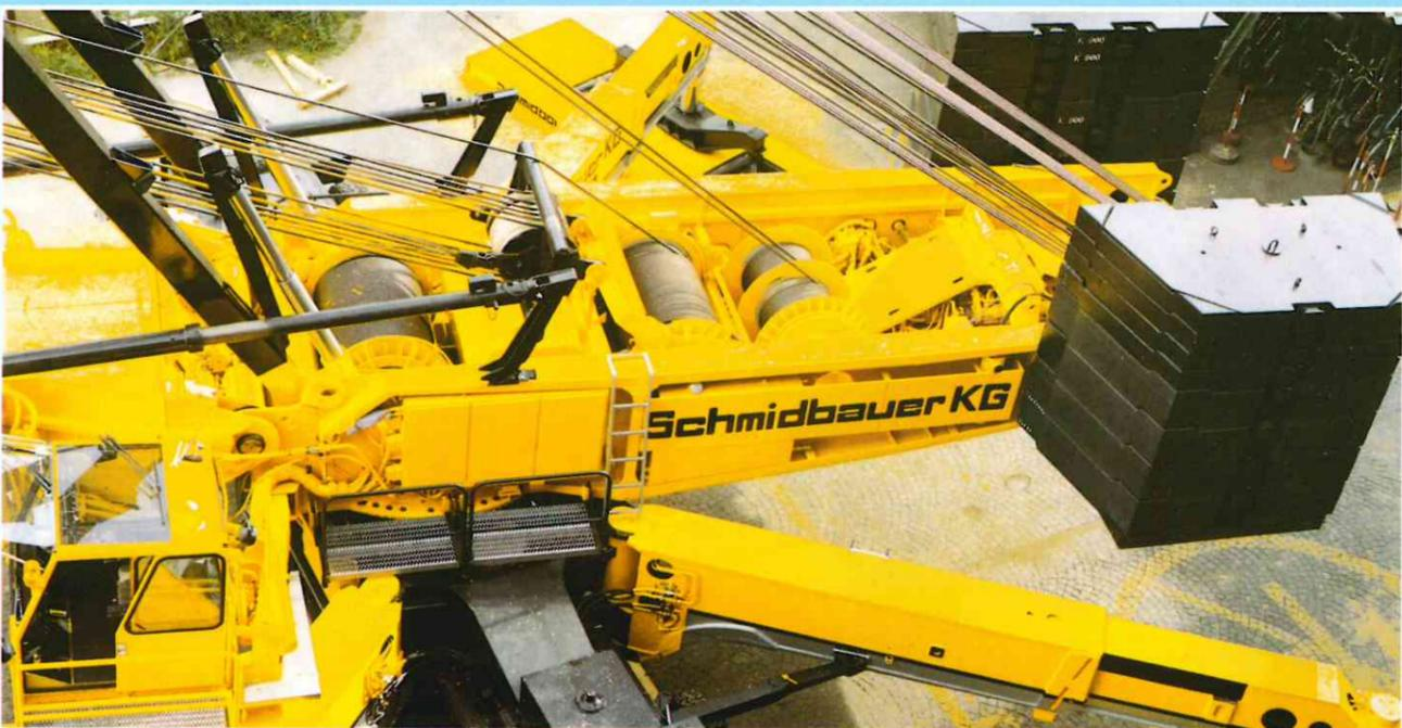
Der Kranantrieb besteht aus dem 405 PS starken Daimler-Benz Dieselmotor und den 5 leistungsgeregelten Verstellpumpen. Neben der Einziehwerkswinde können 3 weitere Winden in der Drehbühne verbolzt werden. Die Antriebe werden im geschlossenen Ölkreislauf gefahren. Die zum Beispiel beim Senken der Last frei werdende Energie kann direkt für eine weitere
