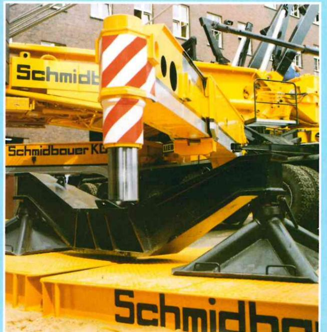
Die 4 Schwenkarme sind sternförmig am Rahmensockel angelenkt. Durch diese direkte Kräfteinleitung in die Holme entfällt eine Torsionsbeanspruchung des Fahrzeugrahmens; die Elastizität ist im gesamten Drehbereich konstant.
