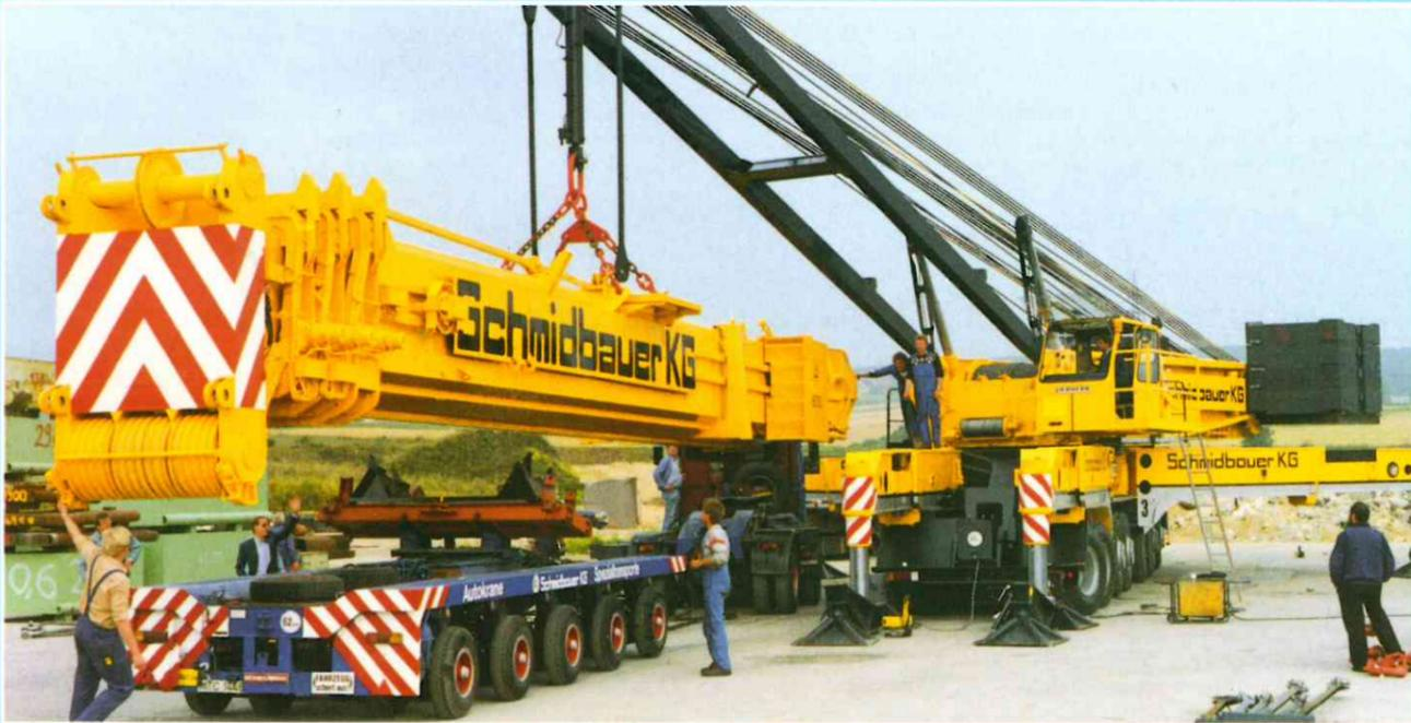
Einfach und schnell wird der Teleskopausleger montiert. Mit einem Zugzylinder am Aufrechtbock und dem Kettengeschirr wird der Ausleger vom Sattelzug aufgenommen und in die Längsachse zur Drehbühne geschwenkt. Durch Verstellen des Aufrechtbocks schiebt sich der Auslegerfuß in die Lagerung der Drehbühne
