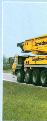
Mobilität für die Straße - mit dem 8achsigen Fahrgestell, dem 530 PS starken Turbodieselmotor, dem 5s Kompakt rollt der Kran zum Einsatz - mit dem hydraulisch in die Drehbühne abgelegten Aufstellbock, dem eingeklappten 4-Punkt-Sternabstützung sowie der eingeschwenkten und abgesenkten Krankabine. Gesamtgewicht - durch die Niveaumatik-Federung. Sie nivelliert den Kran über Straßen, unter Brücken, durchs Gelände.
