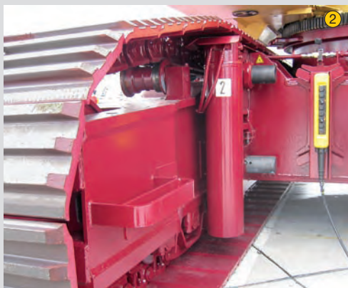
Jack-Up-Zylinder mit einteleskopiertem Raupenträger
