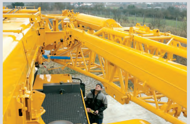
Hydraulische Montagehilfe zum Anbau der Klappspitze
