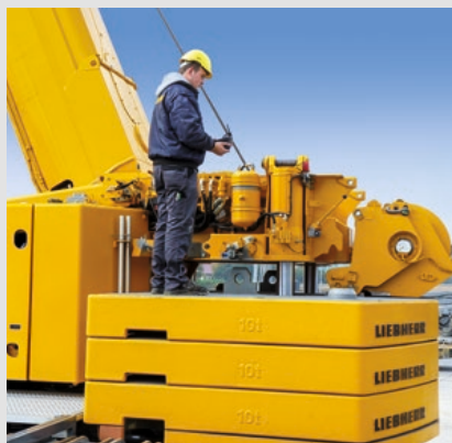
Selbstmontage von Ballast und optionalem Hubwerk 2
