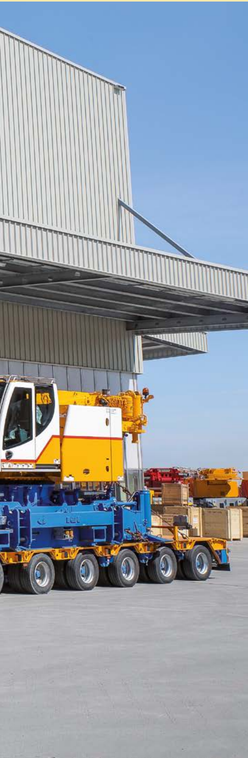
Grundgerät mit Jack-Up Zylindern und Querträger
