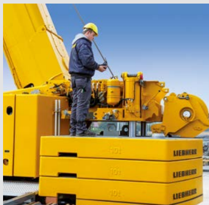
Selbstmontage von Ballast und optionalem Hubwerk 2
