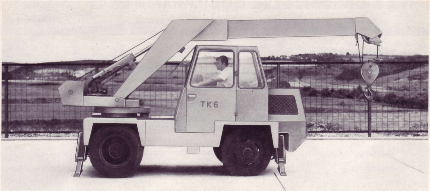
Mobilkran TK6 in Fahrtstellung
