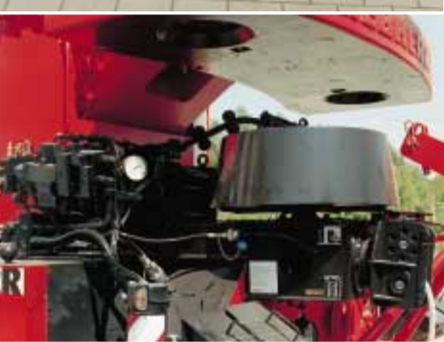
Rotzler-Bergwinde, Typ Treibmatic TR 200, 20 t Zugkraft konstant über die gesamte Seillänge, Seillänge 70 m, Seilgeschwindigkeit stufenlos 5 m/min bis 30 m/min - lastabhängig
