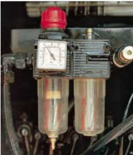
Luftanschluss mit Lufttrockner zum Betrieb diverser Werkzeuge
