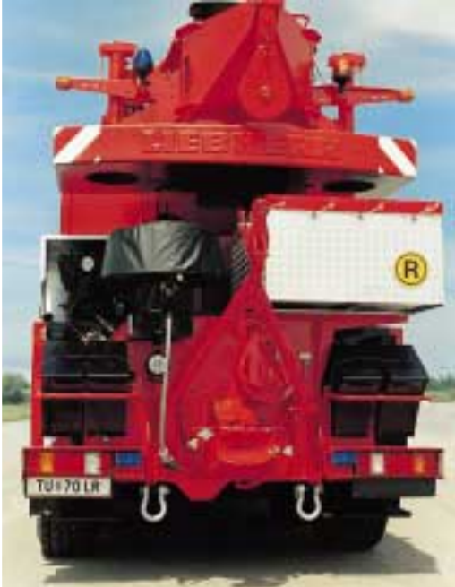
20 t Bergwinde, Abschleppvorrichtung mit einer max. Traglast von 8 t, Anhängerkupplung, 16 t Schäkel am Heck des Fahrzeugrahmens
