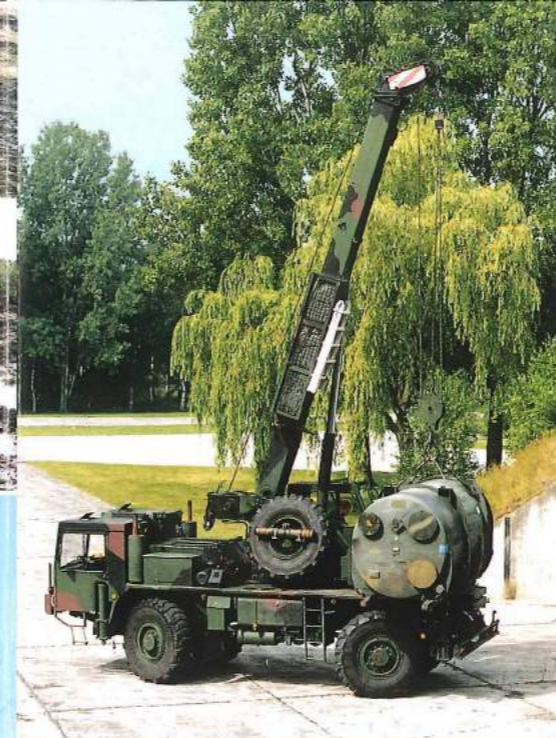
FKL und FKM durchfahren schwieriges Gelände mit einer Wassertiefe bis 1,2 m.
