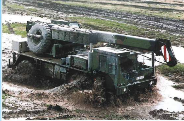
FKL und FKM durchfahren schwieriges Gelände mit einer Wassertiefe bis 1,2 m.
