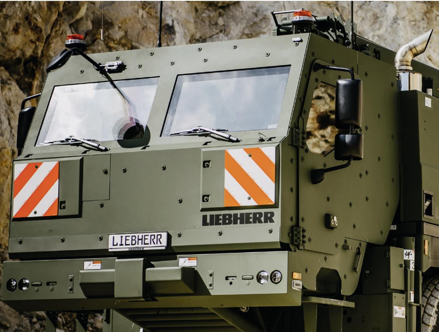
Die Sicherheit der Soldaten steht an erster Stelle. Zur Erfüllung der hohen Schutzanforderungen in diesem Bereich arbeitet Liebherr mit dem führenden europäischen Systemhaus für Heerestechnik, der Rheinmetall Defence, für die Bereiche geschütztes Fahrerhaus und geschützte Krankabine zusammen.
