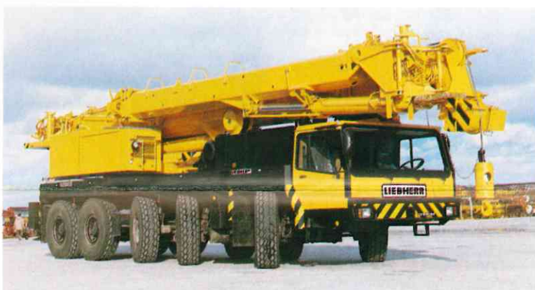
Mobilkran Typ LTM 1100/1 mit Quick Jib.
