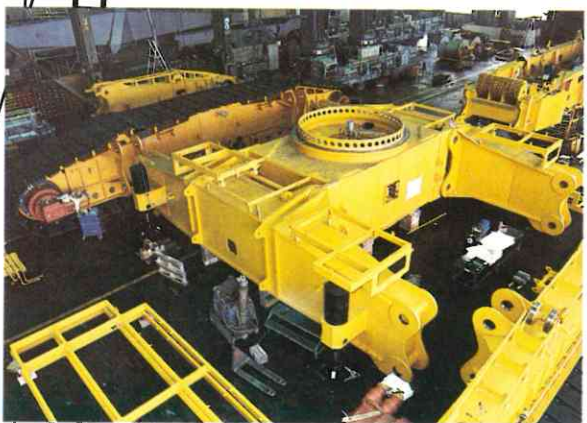
Raupenkran Typ LR 11200 in der Endmontage.
