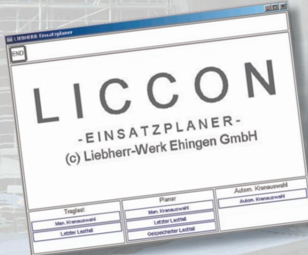
Voraussetzung für die Entwicklung der umfangreichen Software war die datenmäßige Erfassung aller möglichen Betriebszustände eines jeden Liebherr-Mobilkrans, der mit der LICCON-Computeranlage ausgestattet ist. Für jeden Mobilkran wird also die Software speziell konfiguriert und archiviert. Daraus ergeben sich die vielfältigen Möglichkeiten des LICCON-Einsatzplaners, der aus drei Modulen besteht, die mit einem Menüprogramm verwaltet werden.
