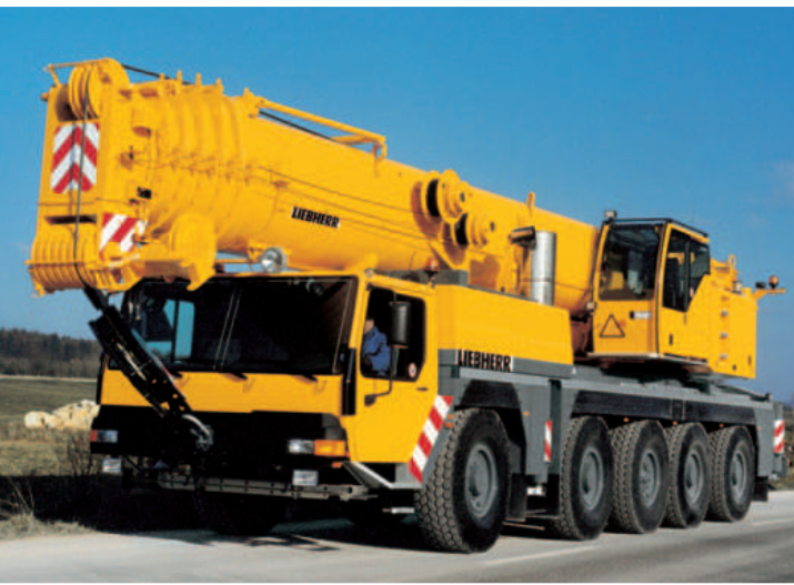
Mobilkran LTM 1200/1, max. Traglast 200 Tonnen, mit LI-AS-DRIVE.
