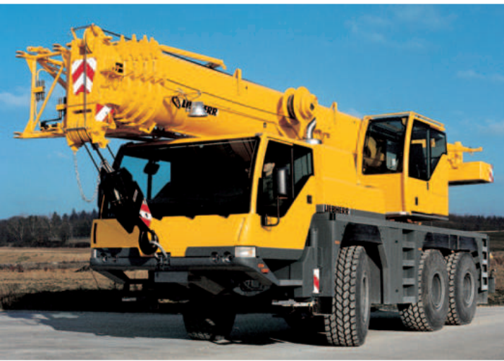
Mobilkran LTM 1055/1, max. Traglast 55 Tonnen, mit LI-AS-DRIVE.
