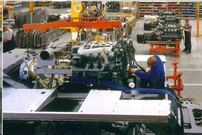
Vormontage und Einbau von Dieselmotoren.
