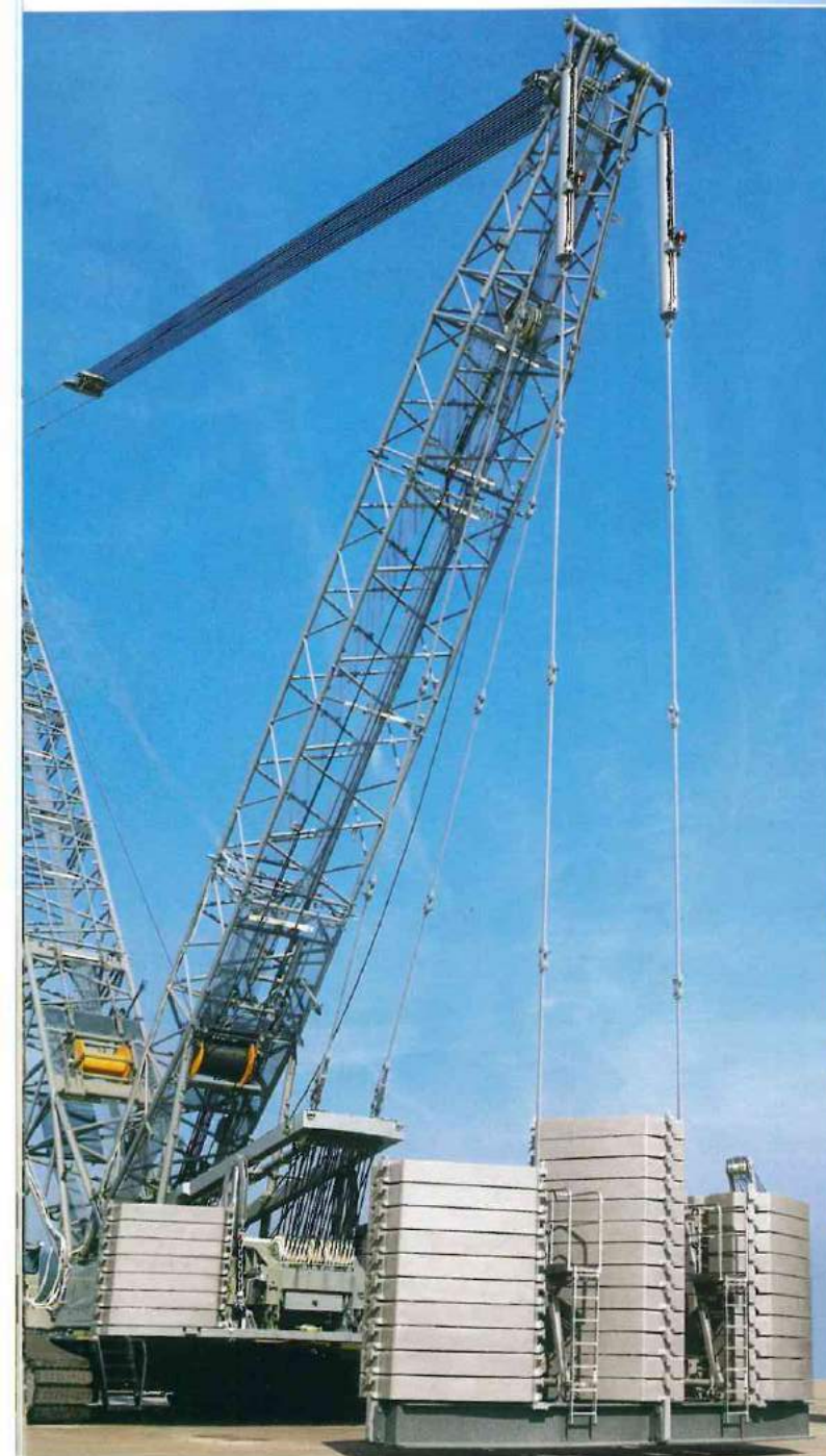
Schwebeballast am Raupenkran LR 1350/1.
