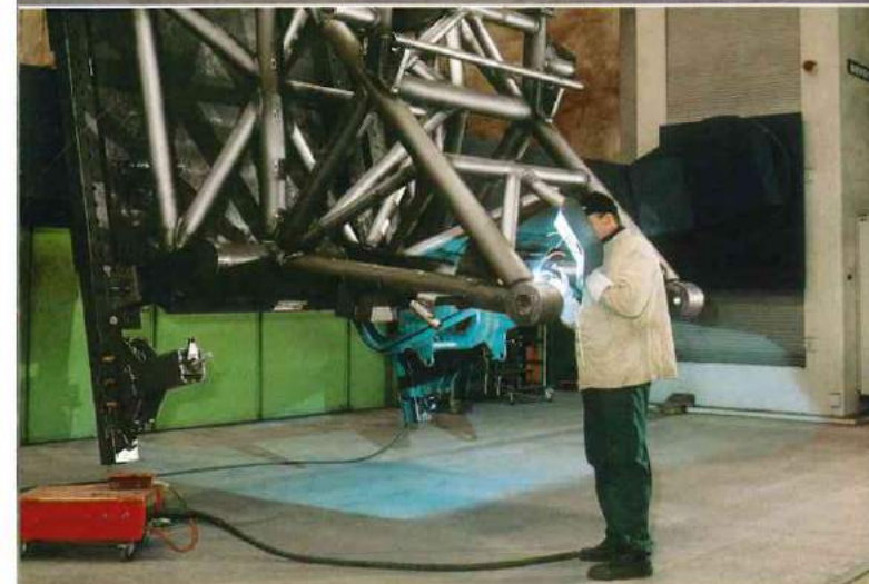
Gitterausleger in Schweißvorrichtung.
