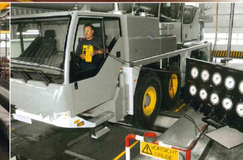
Mobilkran auf Bremsenprüfstand.
