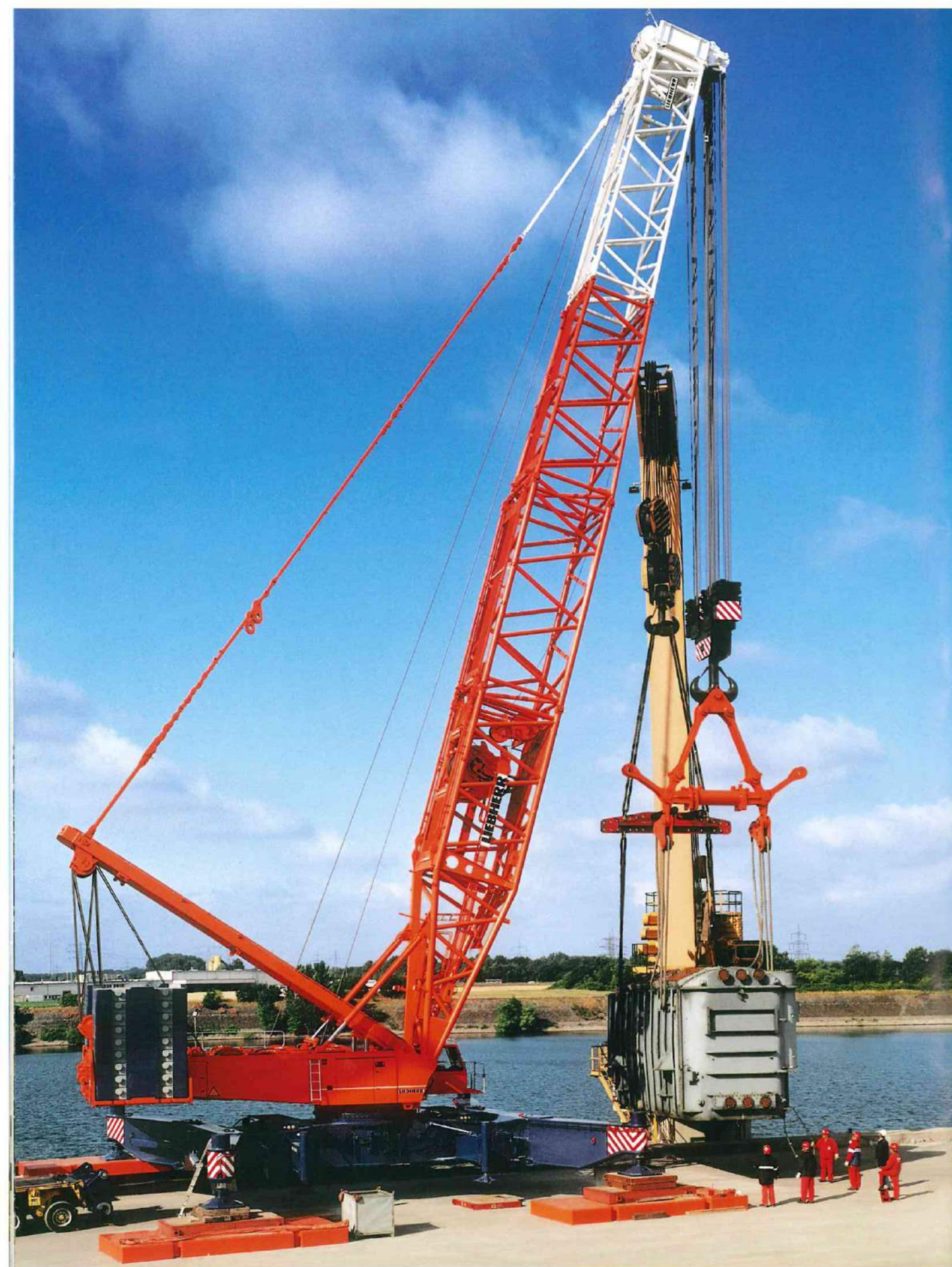
Verladen eines über 300 t schweren Transformators.
