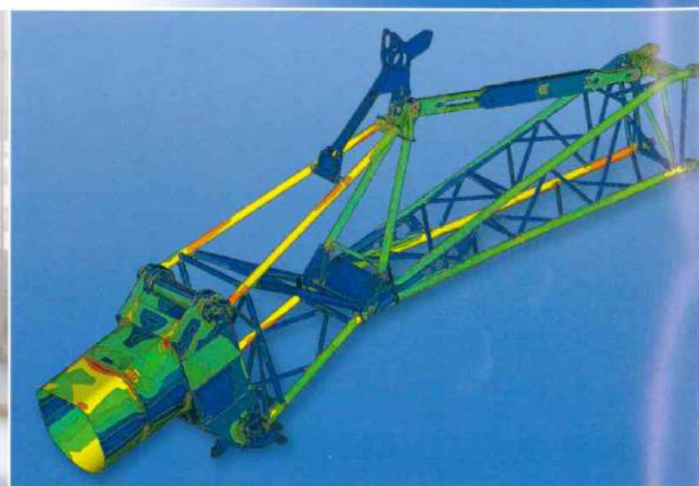
Festigkeitsanalyse von Bauteilen mit Hilfe der Finite-Elemente-Methode.
