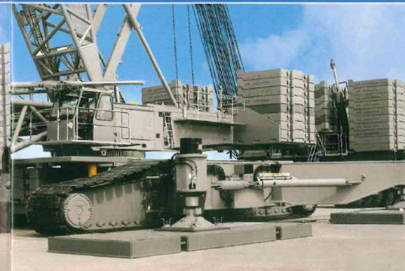
Abstützvorrichtungen am Raupenkran LR 1750.
