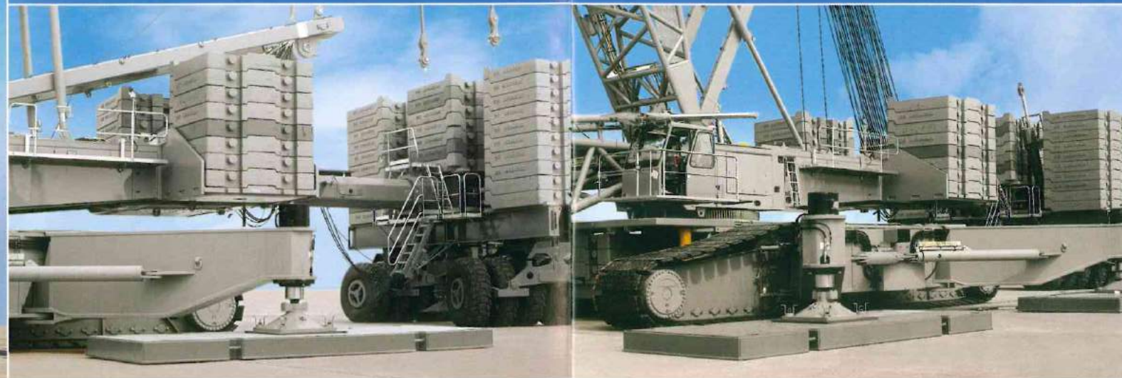
Ballastwagen am Raupenkran LR 1750.
