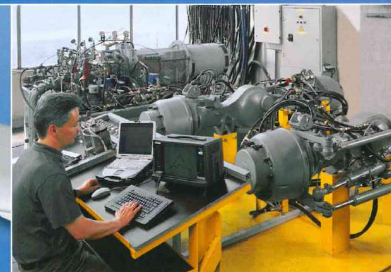
Versuchsaufbau aktive Hinterachslenkung.
