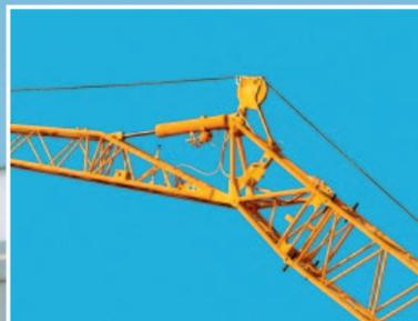
Hydraulikzylinder zur stufenlosen Verstellung der Klappspitze
