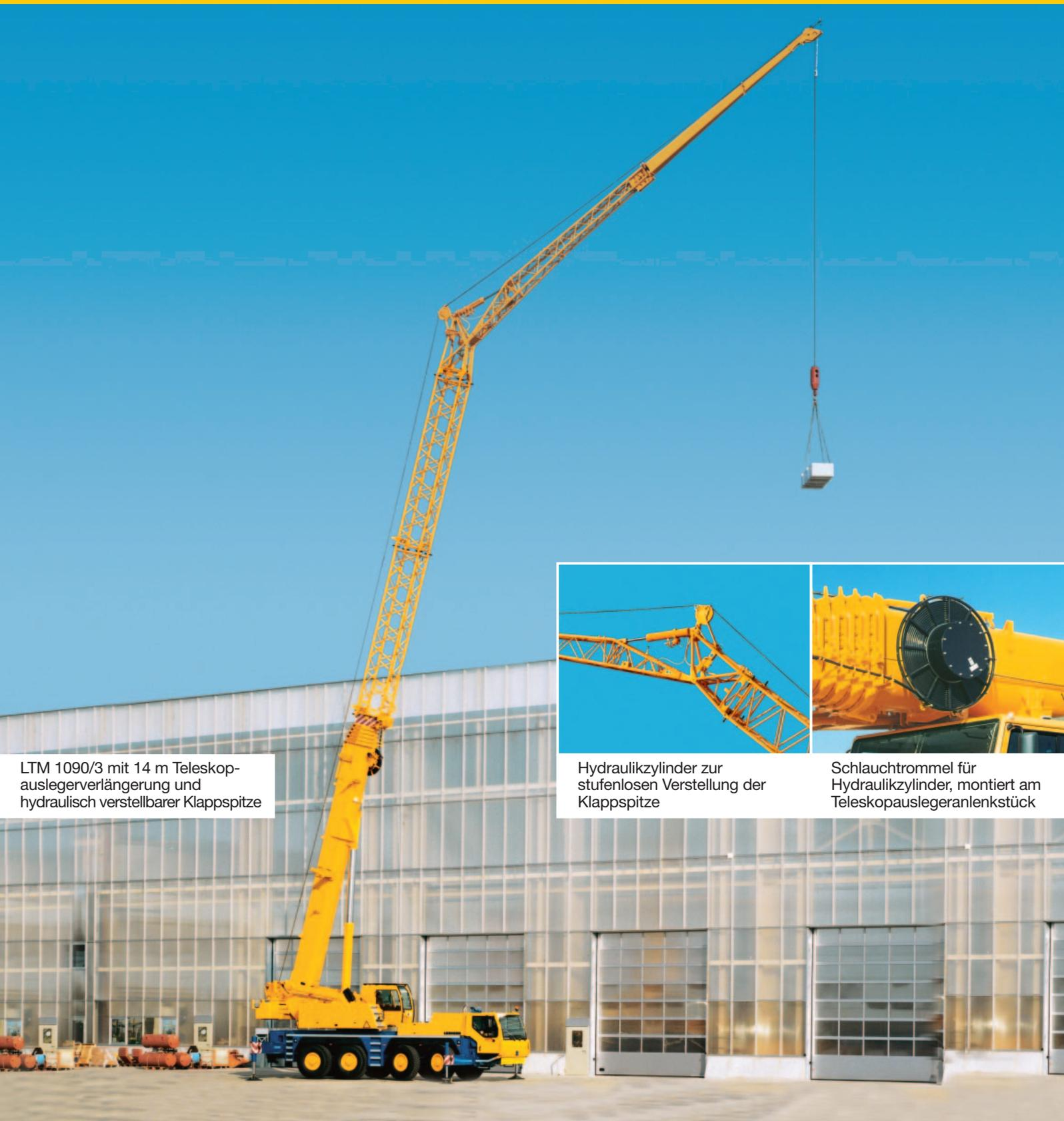
LTM 1090/3 mit 14 m Teleskopauslegerverlängerung und hydraulisch verstellbarer Klappspitze
