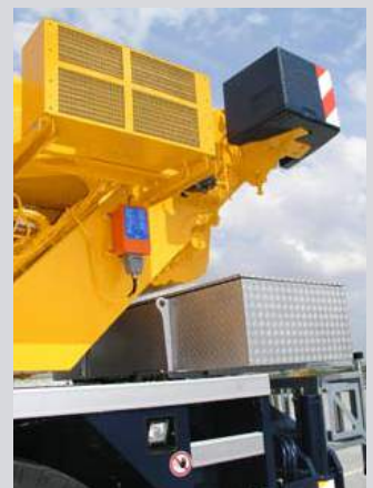
Empfangsgerät am Kran montiert.
