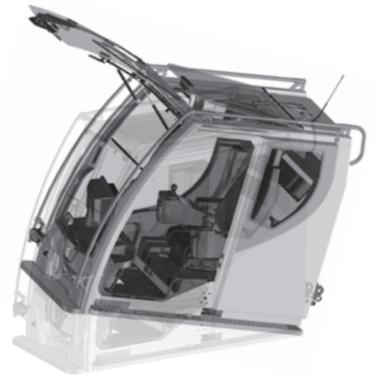
Kippbare Kabine: um 20° nach hinten neigbar
