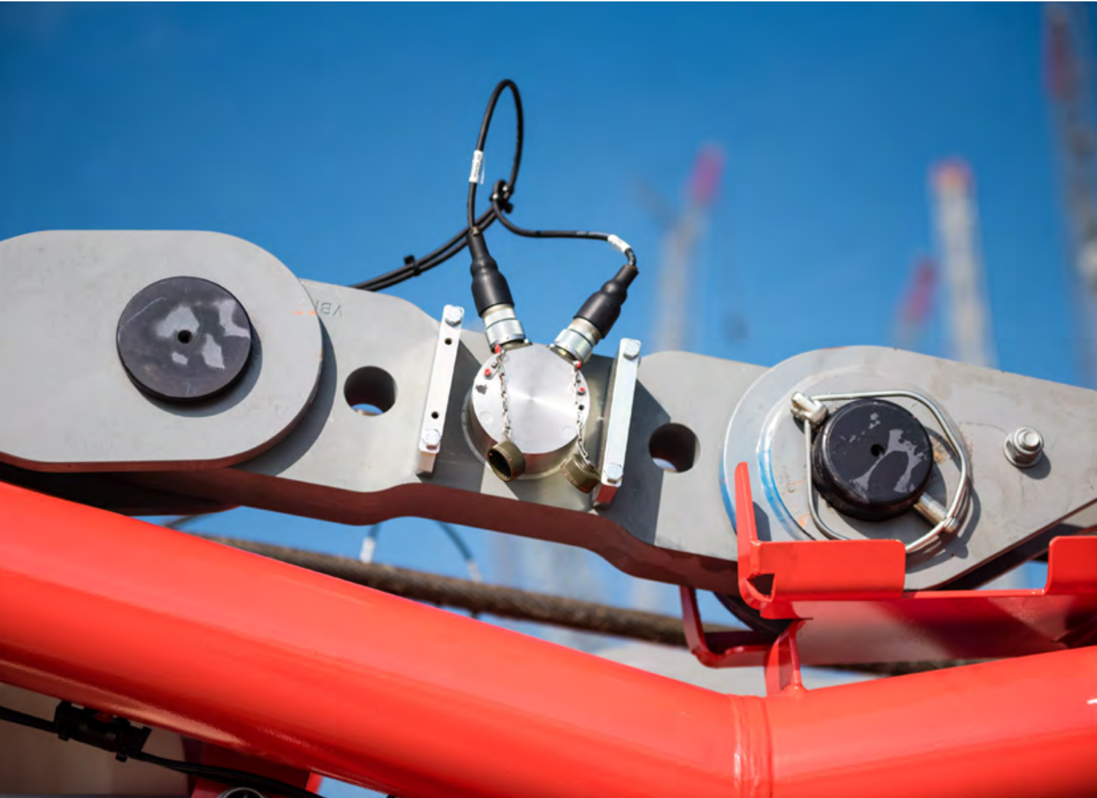
Zugmesslasche mit 2 Messstellen (Stecker) jeweils zweikanalig
