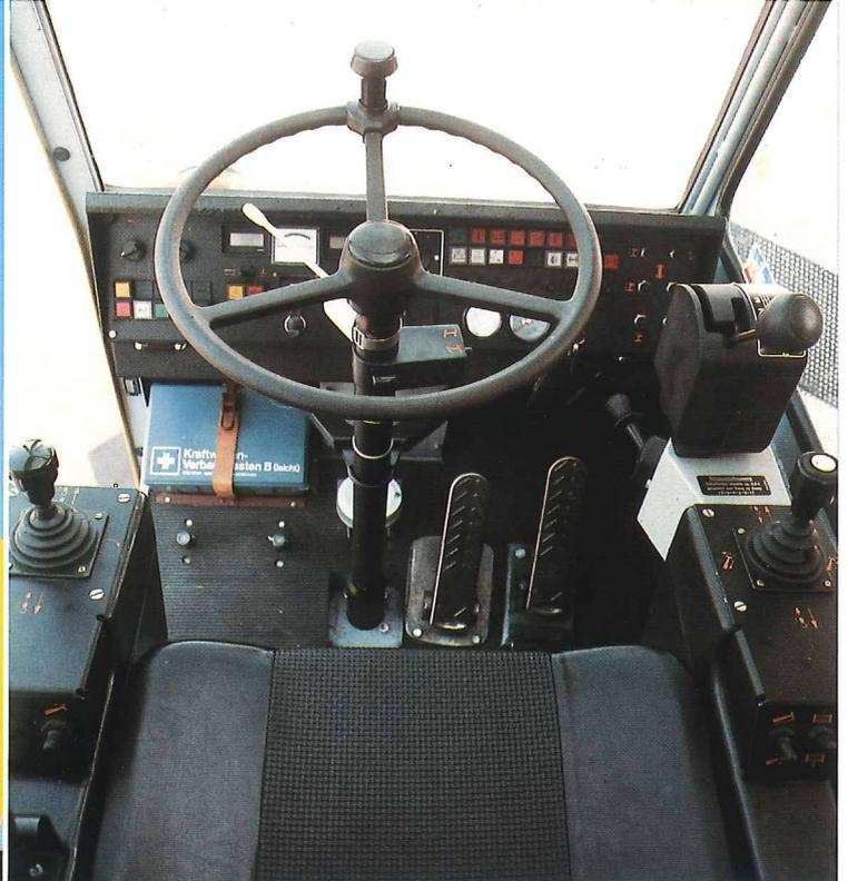
Rundumsicht bietet die geräumige Krankabine, aus der alle Fahr- und Arbeitsbewegungen gesteuert werden. Der Einstieg wird durch einen sicheren Aufstieg und die breite Schiebetüre erleichtert. Die Bedien- und Kontrollinstrumente sind standardisiert. Dies erleichtert dem Kranfahrer die Bedienung verschiedener Krangrößen, wenn einmal Not am Mann ist. Mehrfach verstellbar ist der hydraulisch
