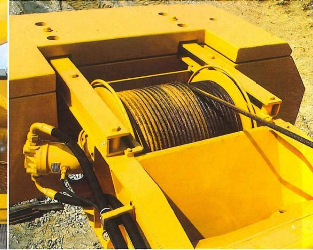
Das Präzisionshubwerk mit eingebautem Planetengetriebe ist praktisch wartungsfrei. Auf der Instrumententafel zeigt der Impulsgeber die Trommelbewegung an.
