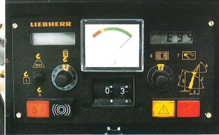
Ein Arbeitsplatz für viele Stunden täglich. Übersichtlich durch eine Instrumententafel mit leicht verständlichen und standardisierten Symbolen. Bequem durch den Komfortsitz mit der integrierten Armlehnensteuerung. Sicher durch Rundum-Sicherheitsverglasung und Totmannschalter zur Absicherung unkontrollierter Kranbedienung.
