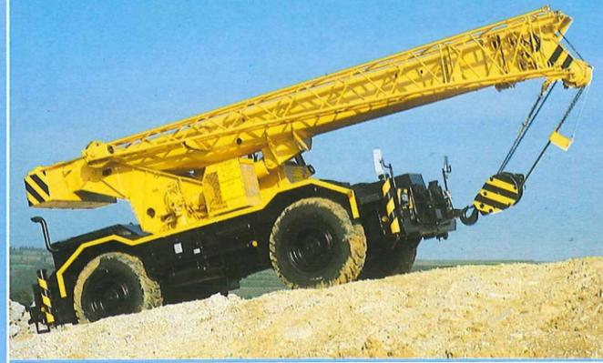
32 m Hubhöhe bringt die 8 m lange Klappspitze. Bei 40 kN Seilzug wird die max. Traglast an der Spitze mit einem Seilstrang gefahren.
