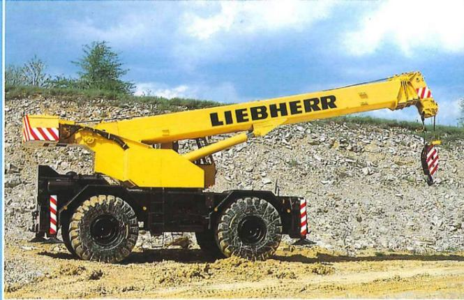
Den Kran verfahren bedeutet Sicht haben nach allen Seiten. Dazu wird der Teleskopausleger nur leicht angehoben und das Blickfeld erweitert sich für den Kranfahrer um 100 %.
