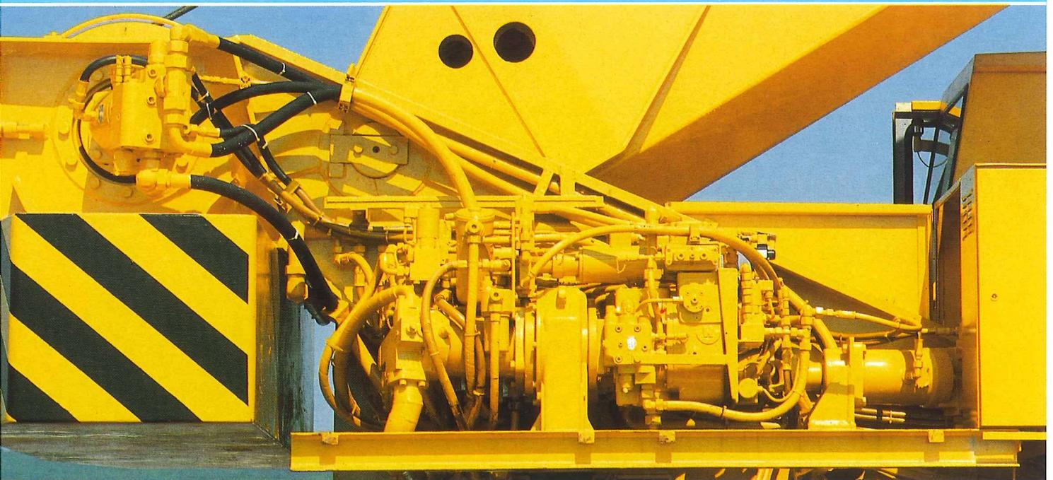
Zur Kranhydraulik gehört ein geschlossener Ölkreis zwischen Ölpumpe am Dieselmotor, der hydraulischen Drehdurchführung und dem Hydromotor am Pumpenverteilergetriebe. Im geschlossenen Kreislauf arbeiten außerdem Hubwerk und Drehwerk, für die insgesamt 3 Verstellpumpen mit automatischer Leistungsregelung installiert sind. Wipp- und Teleskopierwerk haben einen zusätz-
