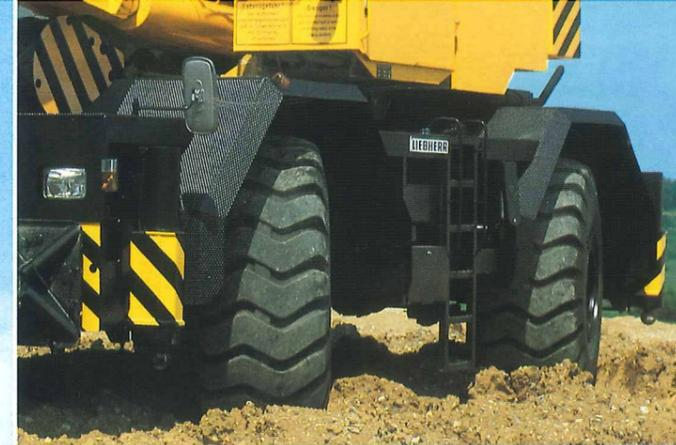
Allradantrieb und Allradlenkung sind bei Geländekranen selbstverständlich. Bei Liebherr gibt es darüber hinaus noch den Hundegang zum seitlichen Versetzen des Gerätes auf engen Baustellen.
