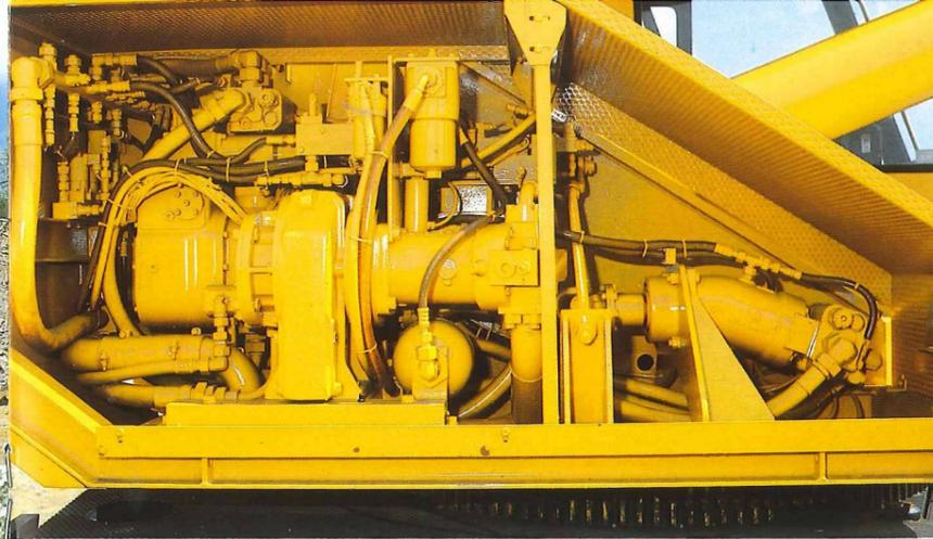
Beim Kranantrieb kommt der LTL 1060 mit 3 leistungsgeregelten Verstellpumpen aus. Hubwerk und Drehwerk arbeiten mit geschlossenem Ölkreis. Gesteuert wird elektrohydraulisch; eine präzisere Geschwindigkeitsregelung der Arbeitsbewegungen gibt es nicht.
