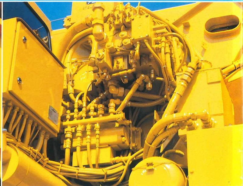
**Der Rotationsmengenteiler arbeitet nach dem Prinzip einer Dreifach-Zahnradpumpe und versorgt die offenen Ölkreise für Hub- und Drehwerk sowie Wipp- und Teleskopierwerk. Über Proportionalventile werden bis zu 3 Kranbewegungen gleichzeitig hydraulisch angesteuert und die Arbeitsgeschwindigkeiten feinfühlig, lastunabhängig geregelt.**
