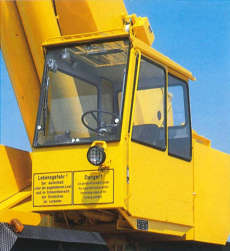
Rundumsicht bietet die geräumige Krankabine, aus der alle Fahr- und Arbeitsbewegungen gesteuert werden. Der Einstieg wird durch einen sicheren Aufstieg und die breite Schiebetüre erleichtert. Die Bedien- und Kontrollinstrumente sind standardisiert. Dies erleichtert dem Kranfahrer die Bedienung verschiedener Krangrößen, wenn einmal Not am Mann ist.
