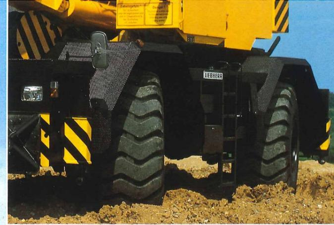
Allradantrieb und Allradlenkung sind bei Geländekranen selbstverständlich. Mit dem Hundegang kann das Gerät in Diagonalfahrt auf engen Baustellen seitlich versetzt werden.
