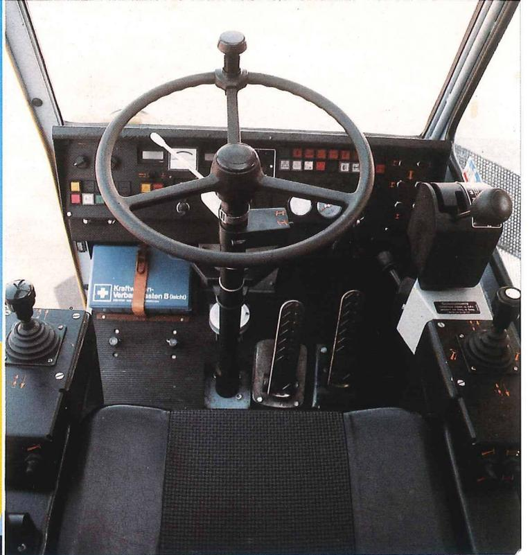
Mehrfach verstellbar ist der hydraulisch gedämpfte Fahrersitz. Die 2 Meisterschalter sind in den Armlehnen integriert. Sicherheit wird großgeschrieben: Schalter für die Freigabe der Steuerung im Steuerhebel, in der Armlehne und am Fahrersitz – der Kran gerät so nicht außer Kontrolle, wenn unbeabsichtigt Kranbewegungen ausgeführt werden.
