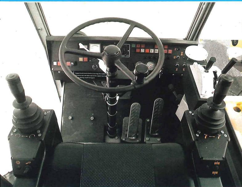
Ein Arbeitsplatz für viele Stunden täglich. Übersichtlich durch eine Instrumententafel mit leicht verständlichen und standardisierten Symbolen. Bequem durch den Komfortsitz mit der integrierten Armlehnensteuerung. Sicher durch Rundum-Sicherheitsverglasung und Totmannschalter zur Absicherung unkontrollierter Kranbedienung.
