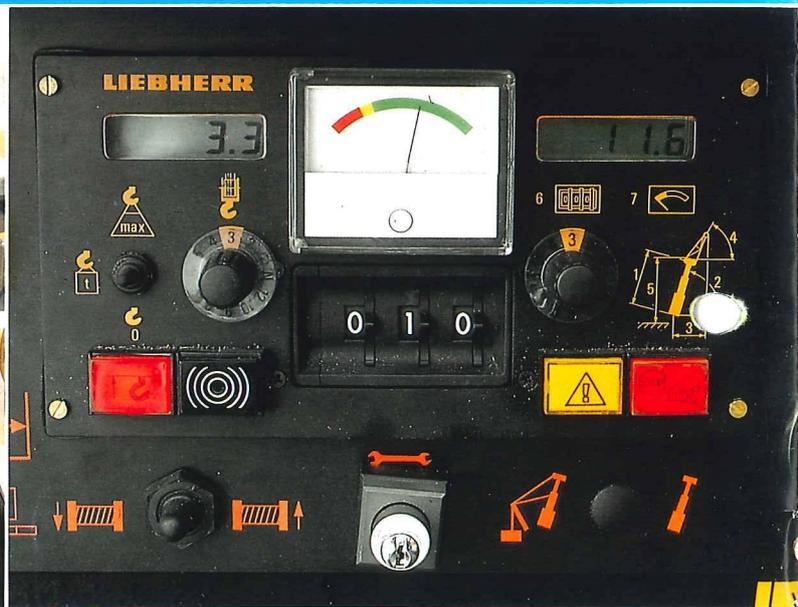
Erhöhte Sicherheit und Zuverlässigkeit sowie verbesserten Bedienungskomfort bietet die elektronische Lastmomentbegrenzung. Netto-/Bruttolast, Ausladung, Auslegerlänge und Hubhöhe werden auf Abfrage digital angezeigt. Den Grad der Kranauslastung sieht der Kranfahrer zusätzlich auf der Analoganzeige. Die Eigendiagnose läßt Bedienungsfehler schnell erkennen, so daß eine zeitraubende Fehlersuche entfällt.
