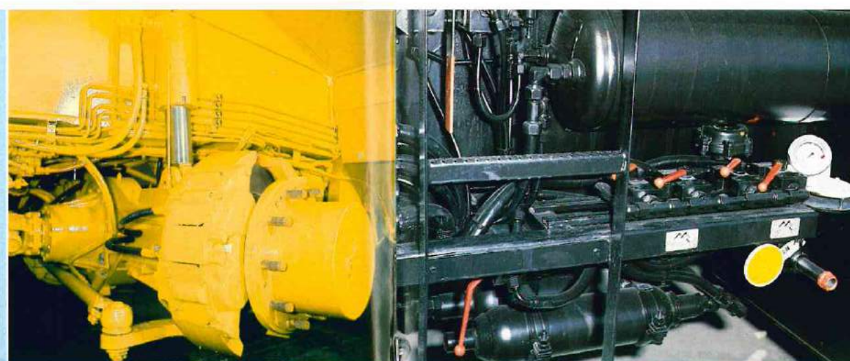
Für Federung, Stoßdämpfung und Blockierung arbeiten 4 Hydraulikzylinder zwischen den Achsen und dem Fahrzeugrahmen.
