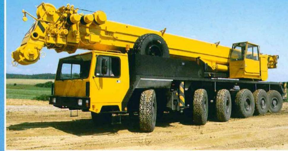
Im Vergleich mit dem stärksten LTM schneidet der LTM 1125 nicht schlechter ab. Bei reduzierter Maximaltraglast von 125 t bietet er auch ein niedrigeres Gesamtgewicht. Wie alle LTM's kann auch dieses Gerät zu jedem Einsatz speziell gerüstet werden: Mit Ballastvarianten von 0-19 t, mit 2. Hubwerk, mit der Klappspitze, oder mit fest und wippbaren Gitterspitzen.
