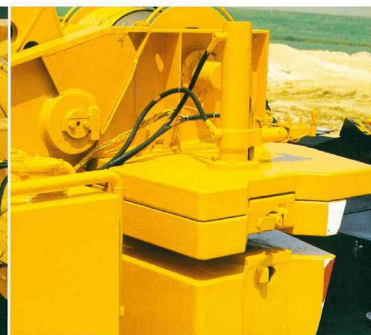
Haupt- und Hilfshubwerk sind bei den LTM's zugleich. Mit innenliegenden Planetengetrieben und federbelasteten Lamellenbremsen sind sie praktisch wartungsfrei.
