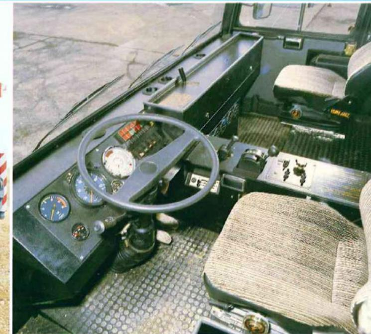
Liebherr-Fahrerhäuser nehmen die gesamte Fahrzeugbreite ein und bieten damit viel Platz für Fahrer- und Begleitpersonen. Die Gehäuse sind gegen Korrosion vollverzinkt und schallisoliert. Hydraulisch gedämpfte Sitze, in der Höhe und Neigung verstell-bares Lenkrad, standardisierte Bedien- und Kontroll-instrumente und viel Ablagefläche und Stauraum für Material und Persönliches von Fahrer und Mitfahrer gehören zur Standardausrüstung.
