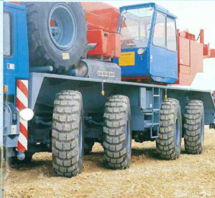
Die zwei- bis vierachsigen LTM's haben Allradlenkung; bei den 5- und 6-Achs-Geräten sind bis zu 4 Achsen gelenkt. In Verbindung mit den kompakten Fahrgestellen ergeben sich ausgezeichnete Wenderradien. Mit Allradlenkung können Sie die Krane auch in Diagonalfahrt in engen Baustellenlücken bewegen. Bis zum 60tonner können die Fahr- und Lenkbe-wegungen auch aus der Krankabine gesteuert werden.
