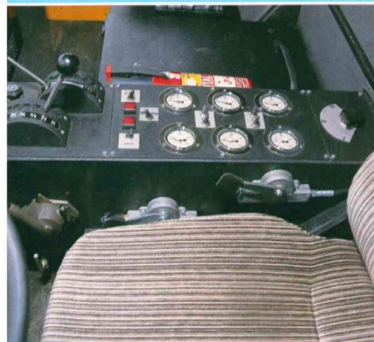
Durch elektrische Fernbedienung aus dem Fahrerhaus wird die "Niveaumatik" auf die 3 möglichen Fahrzustände eingestellt. Manometer zeigen die Drücke in Abhängigkeit zur Federungscharakteristik. Die Steuerung der Komponenten - Hydrozylinder, Achsblockierventile und Blasen Speicher - erhält mit der elektrischen Fernbedienung ein Höchstmaß an Bedienungskomfort.
