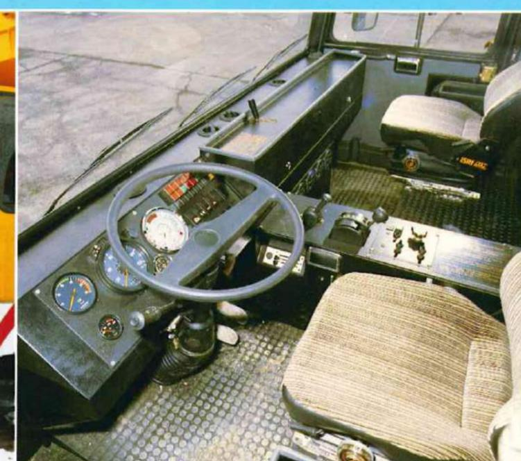
Liebherr-Fahrerhäuser bieten viel Platz für Fahrer und Beifahrer, weil der Fahrzeugmotor außerhalb der Kabine im Fahrzeugrahmen untergebracht ist. Die Gehäuse sind gegen Korrosion vollverzinkt und schall-isoliert. Hydraulisch gedämpfte Sitze, in der Höhe und Neigung verstellbares Lenkrad, standardisierte Bedien- und Kontrollinstrumente und viel Ablagefläche und Stauraum für Material und Persönliches von Fahrer und Mitfahrer gehören zur Standardausrüstung.
