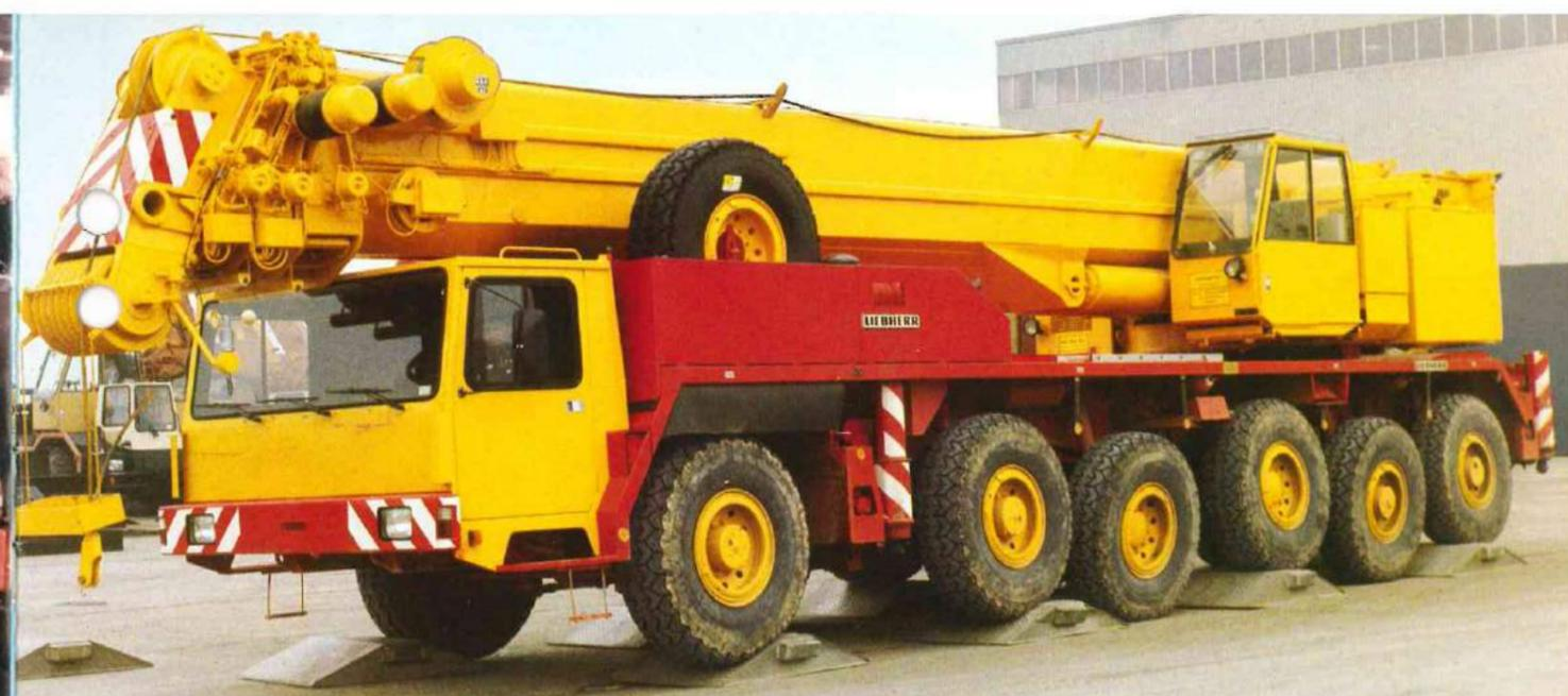
Die „Niveaumatik“ bietet 3 Fahrzustände: Bei Straßenfahrt und Programm 2 sind alle Achsen gefedert, es besteht Achslastausgleich. Mit diesem Programm kann auch die automatische oder manuelle Niveauregulierung zum Heben, Senken oder Kippen des Kranaufbaus gesteuert werden. Über nur einen Kippschalter wird der Zustand „Normalniveau“ mit rüstigster Achslast- und Schwerpunktverteilung eingeregelt.
