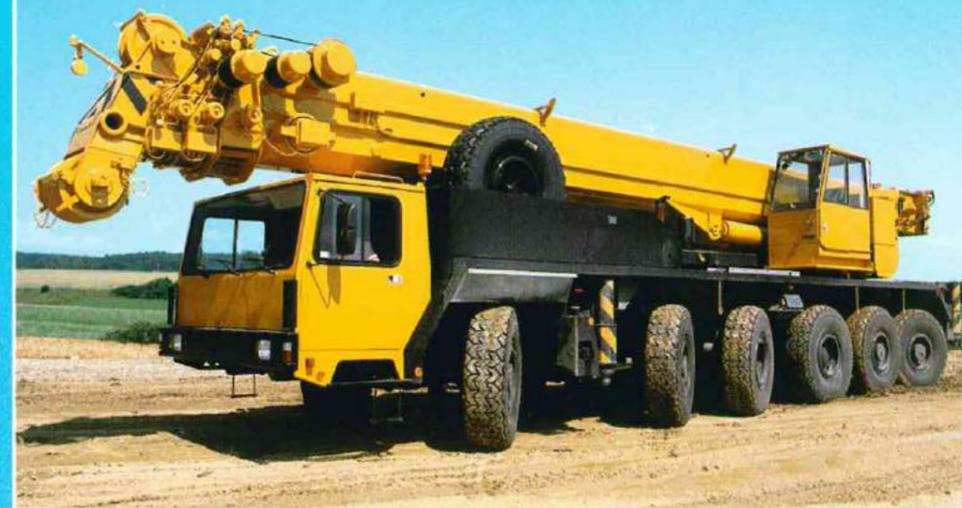
Im Vergleich mit dem LTM 1160 schneidet der LTM 1140 nicht viel schlechter ab. Als 140-Tonner bietet er 72 t Gesamtgewicht inkl. 5 t Ballast. Wie alle LTM's kann auch dieser Kran zu jedem Einsatz speziell gerüstet werden: Mit 45 m langem, 4teiligen Teleskopausleger, mit Ballastvarianten von 0 - 26 t, mit 2. Hubwerk, mit der max. 20 m langen Doppelklappspitze, oder mit fest montierter oder wippbarer Gitterspitze.
