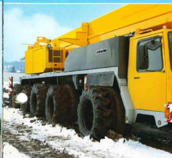
Die Traktorräder (Zusatzausstattung) haben sich im schweren Geländeeinsatz, auf weichen, wenig tragfähigen Böden bestens bewährt. Mittels Schnellverschlüssen sind die Traktorräder einfach zu montieren. Mit verbesserter Traktion und reduzierter Flächenpressung arbeitet sich der 5achsige LTM 1120 zum Einsatz. Bei Montagen von Leitungsmasten im Freiland sind Traktorräder so wichtig wie Mehrachsantrieb, Differentialsperren und die „Niveaumatik“ zur Verbesserung der Geländetauglichkeit.
