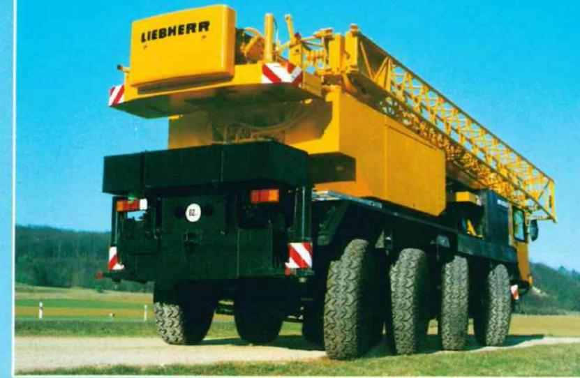
Mit einem Transportgewicht von 48 t inkl. 5,6 t Ballast und 18 m langer Klappspitze wird der Kran zugelassen. Für eine gleich-mäßige Achslastverteilung - in allen Fahrsituationen - sorgt die „Niveaumatik-Federung“.
