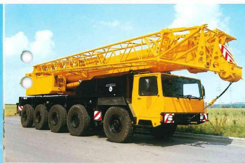
In praxisgemäßen Versuchs- und Meßfahrten – durchgeführt vom Institut für Computeranwendungen der Universität Stuttgart – wurde die „Niveaumatik-Federung“ von Liebherr im Vergleich mit herkömmlichen Federungssystemen getestet und als besonders straßenschonend anerkannt. Durch das niedrige Schwingungsverhalten sind auch die Belastungen für Straßen und Brücken reduziert.
