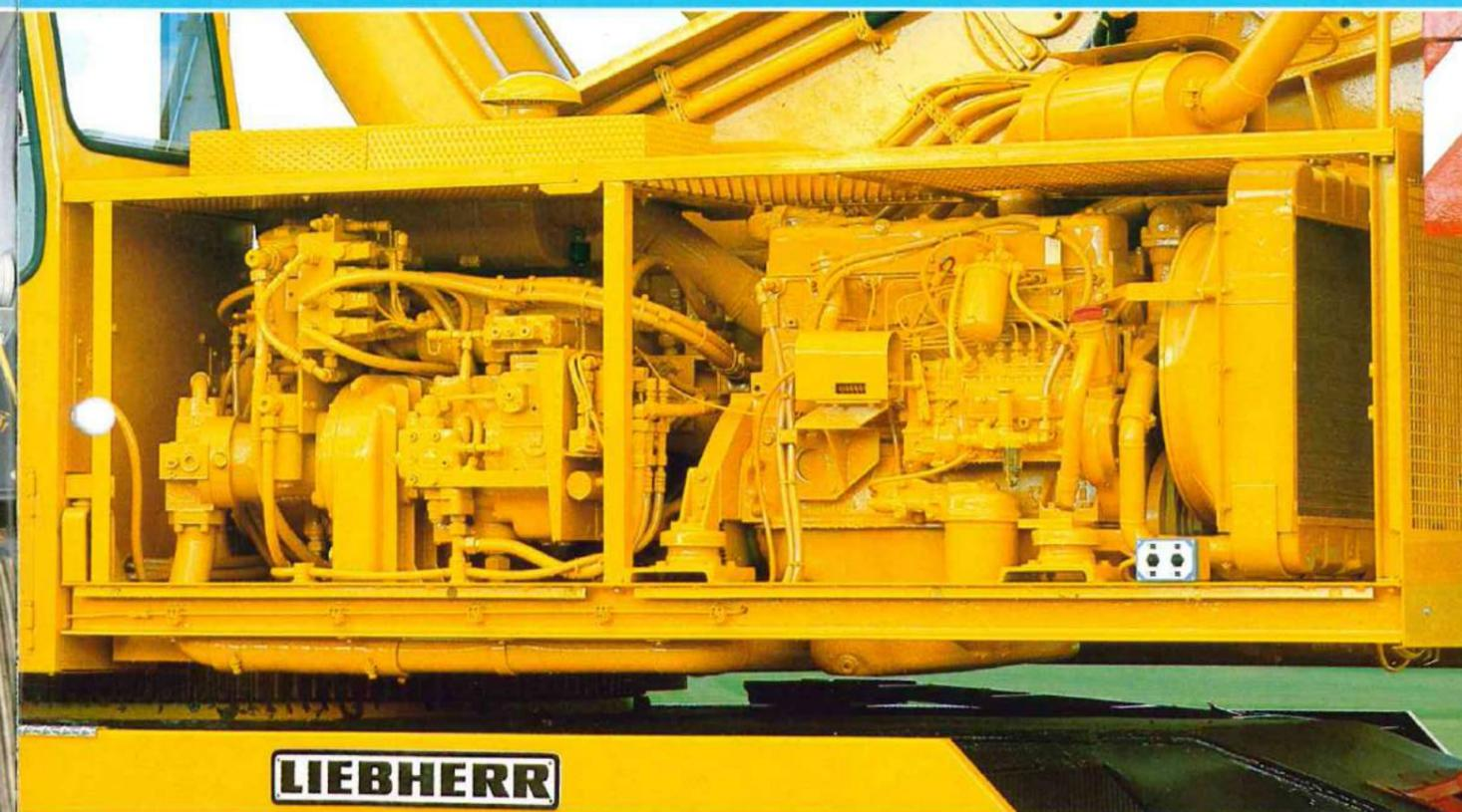
Dieselhydraulischer Kranantrieb mit leistungsgeregelten Verstellpumpen z. B. LT 1090.
