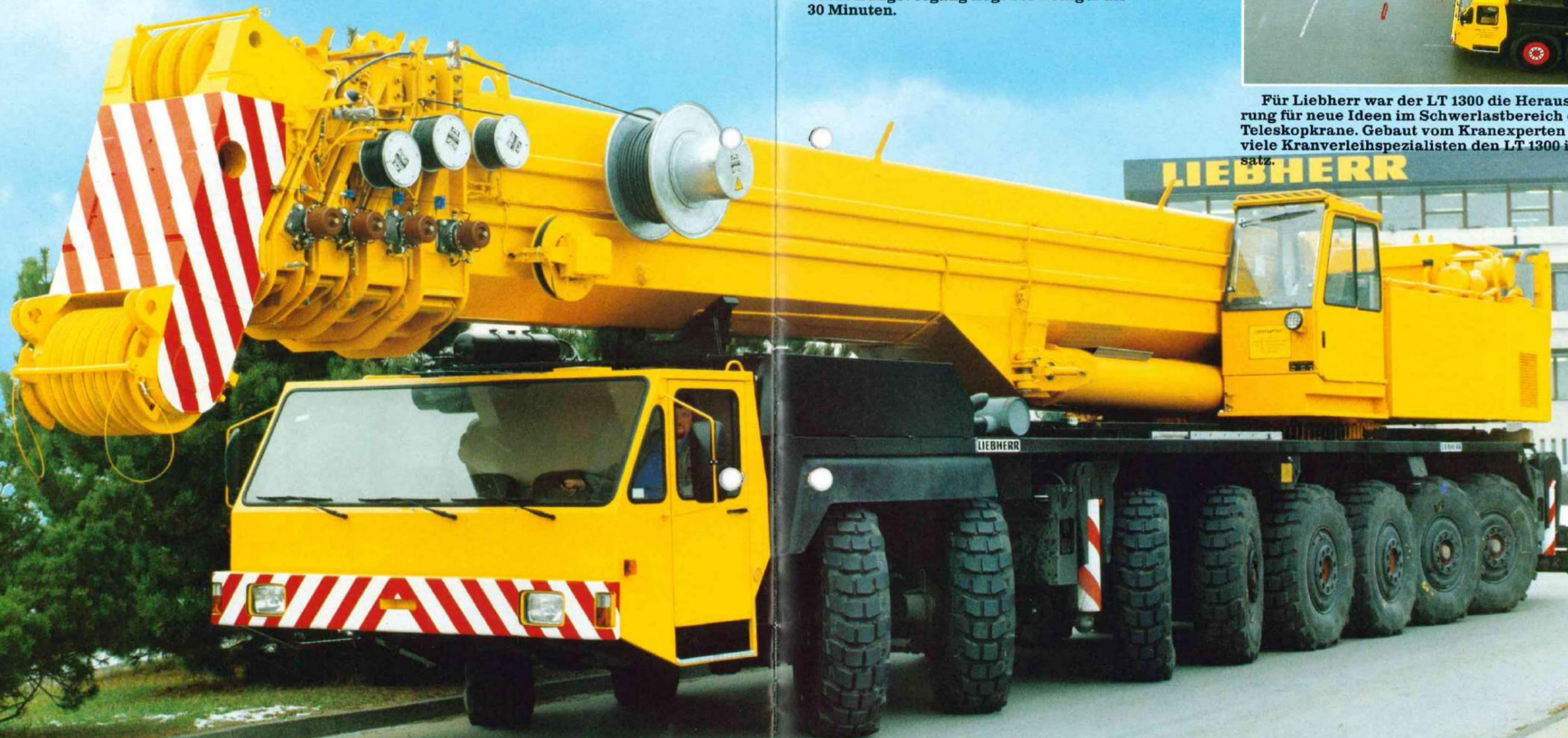
**Die Teleskop-Autokrane bis 330 t Traglast.**
