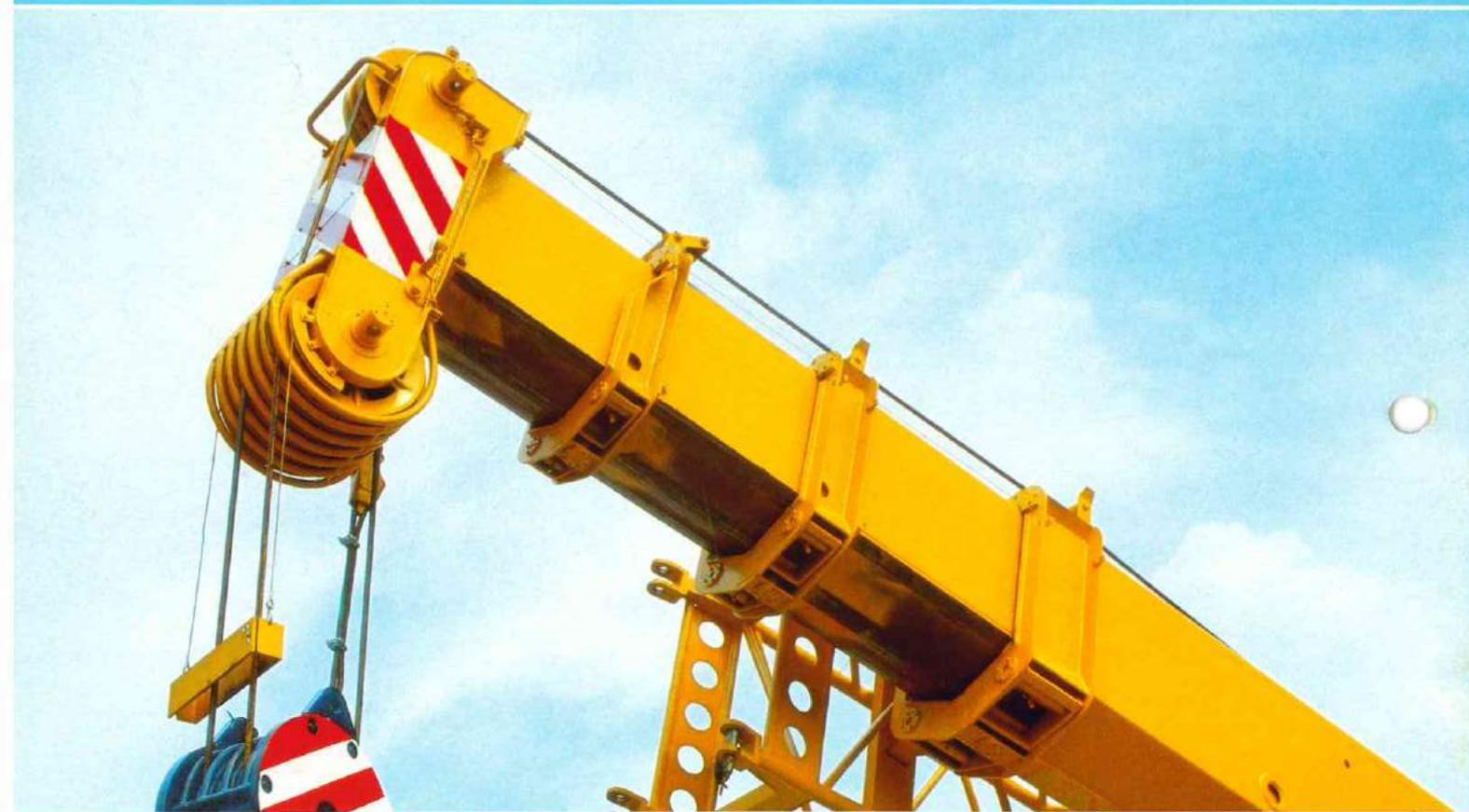
Teleskopausleger mit verstellbaren Lagerschuhen z. B. LT 1090.
