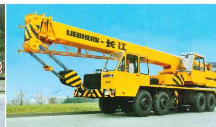
Der LT 1030 mit 30 t Traglast ist der klassische Montagekran oder das „Stand-by“ Gerät. Seine individuelle Note erhält der Kran mit verkürztem Teleskopausleger, z. B. für verstärkten Halleneinsatz oder mit breitem Fahrerhaus für Montagebegleitpersonal.
