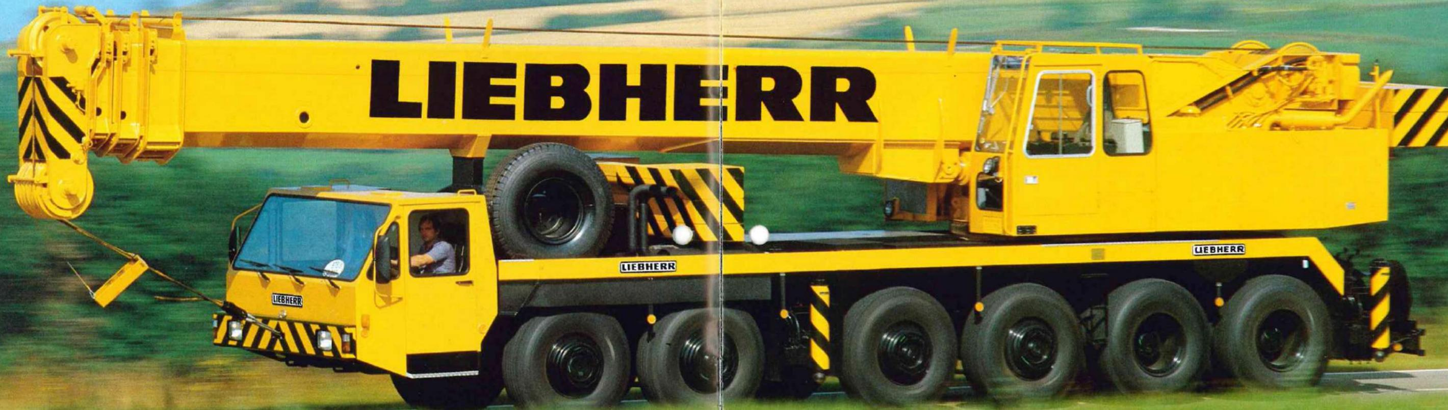
**Die Teleskop-Autokrane bis 120 t Traglast.**
