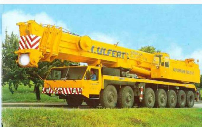
Der LT 1160 mit 160 t Traglast ist die baukastenmäßige Weiterentwicklung des LT 1140. Durch die Verwendung erprobter und bewährter Bauelemente hat dieser Kran einen hohen technischen Standard.
