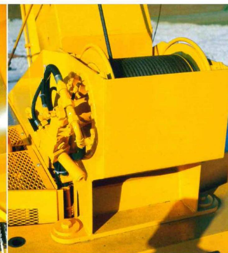
Hubwinde mit innenliegendem Planetengetriebe und Haltebremse z. B. LT 1045.
