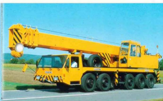
55 t Traglast klassifizieren den LT 1055. Darüber hinaus ist es die besondere Liebherr-Technik, z. B. das eigengefertigte Spezialkran-fahrgestell mit der Vollfederung oder die leistungsgeregelte Kranhydraulik, die diesen Autokran kennzeichnet.
