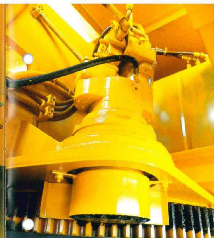
Präzisionsdrehwerk mit Planetengetriebe und federbelasteter Haltebremse z. B. LT 1040.
