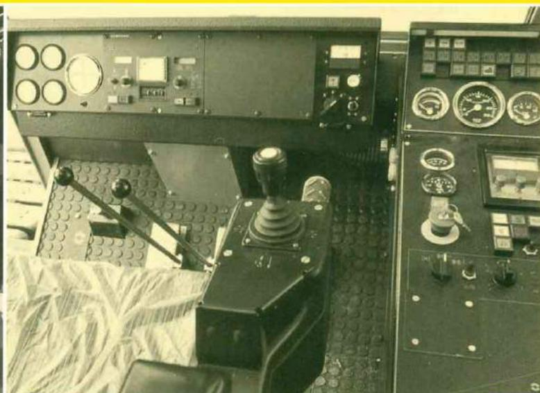
Die Komfort-Kabine bietet übersichtlich angeordnete Bedienungs- und Kontrollinstrumente. Mit der elektronischen Parallelsteuerung können 2 Winden über einen Meisterschalter gefahren werden. Die Funktion des 2-Kanal-Systems der elektronischen Überlastsicherung kann am Anzeigendisplays jederzeit überprüft werden.
