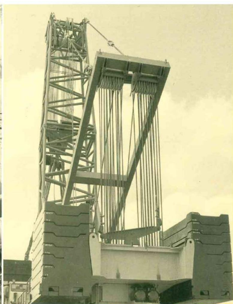
Beim LR 1650 wiegen die Ballastplatten max. 10 t; sie werden beidseitig an der Drehbühne zu einem Gesamtballast von 160 t gestapelt.
