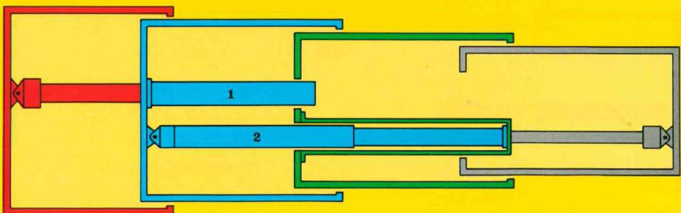
**Das 4stufige vollhydraulische Teleskopiersystem.**
