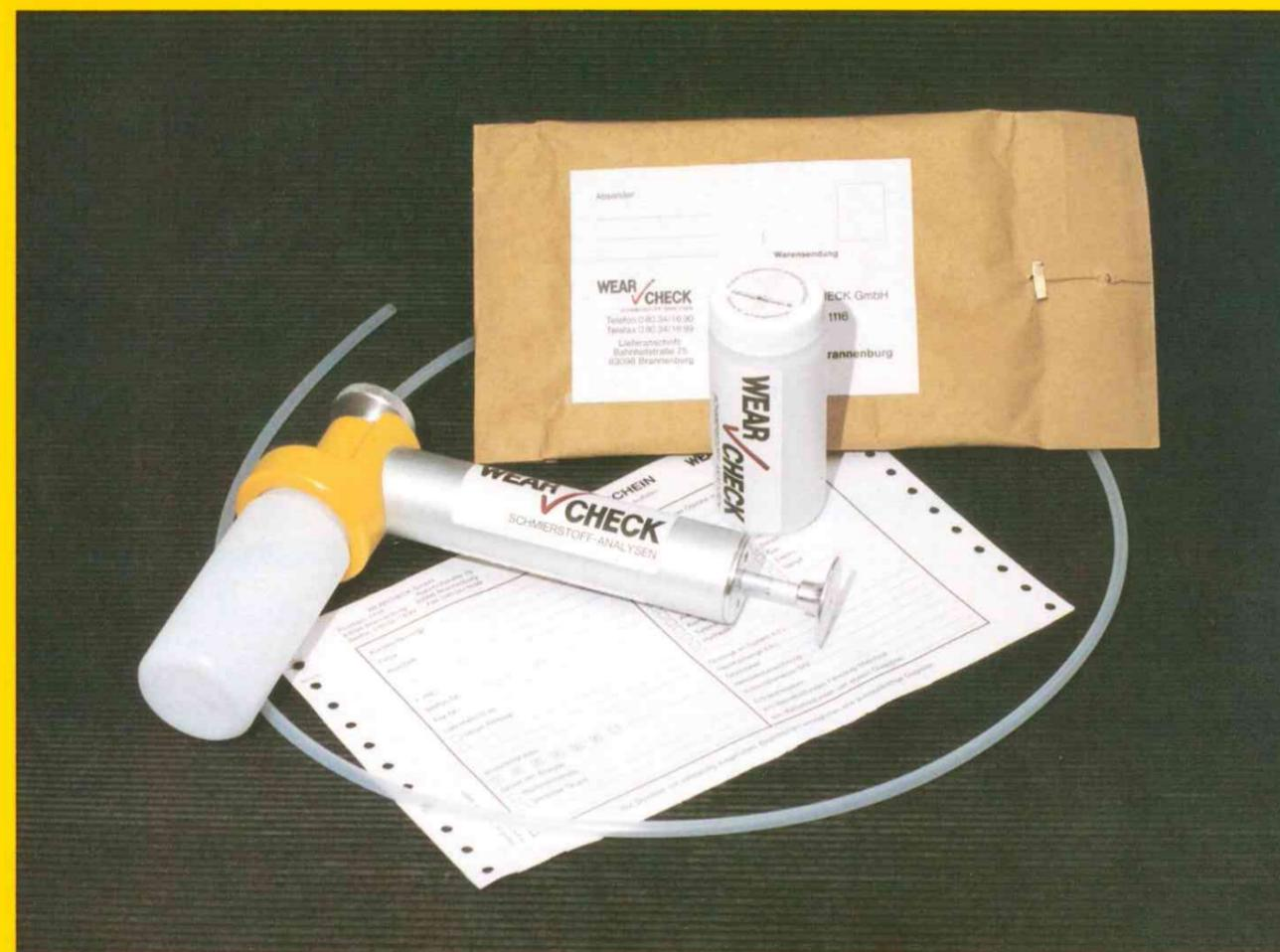
Zwei bis drei Tage nach Eingang der Ölprobe wird dem Kunden per Post oder Fax das Ergebnis der Analyse in Form von über 20 Einzelergebnissen mitgeteilt. Durch die Buchstaben-Kennung können von dem Ergebnis folgende Aussagen abgeleitet werden:
