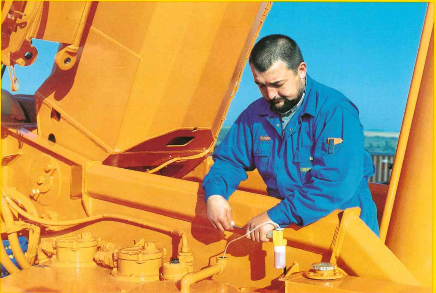
An Hydrauliksysteme in Fahrzeugkranen werden hohe Anforderungen gestellt. Häufigste Ursache für Störungen in hydraulischen Systemen ist verschmutztes bzw. überhitztes Öl, das zum vorzeitigen Verschleiß von Aggregaten und zum Ausfall des Systems führen kann. Die Ölverschmutzungen können folgende Ursachen haben:
