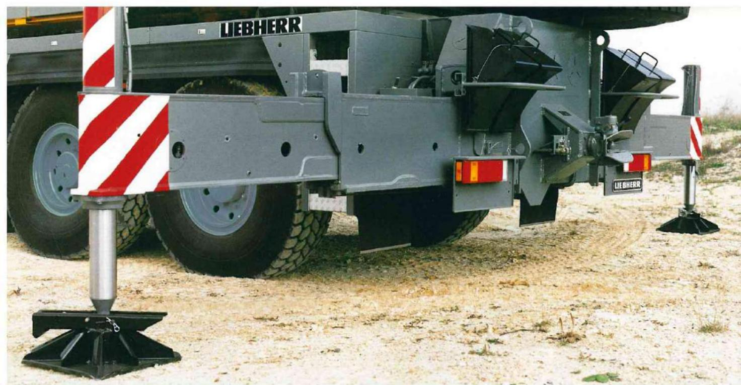
Schnelleinsätze erfordern kurze Rüstzeiten und verschiedene Rüstzustände. Die variable Stützbasis mit ein-, aus- oder halbausgefahrenen Schiebehelmen ist dabei so wichtig wie Abstützzyylinder mit großem Hub. Die LICCON-Anlage bietet als Option die Stützkraftanzeige.
