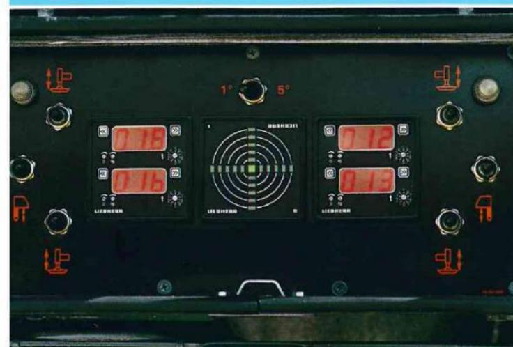
Die Bedienung der Abstützungen erfolgt über zwei Steuertableaus seitlich am Fahrgestell und zusätzlich – als Option – auch aus der Krankabine. Mit beleuchteten und schmutzgeschützten Spiegellinien oder mit elektronischen Neigungsanzeigen (Option) wird der Kran einivelliert.
