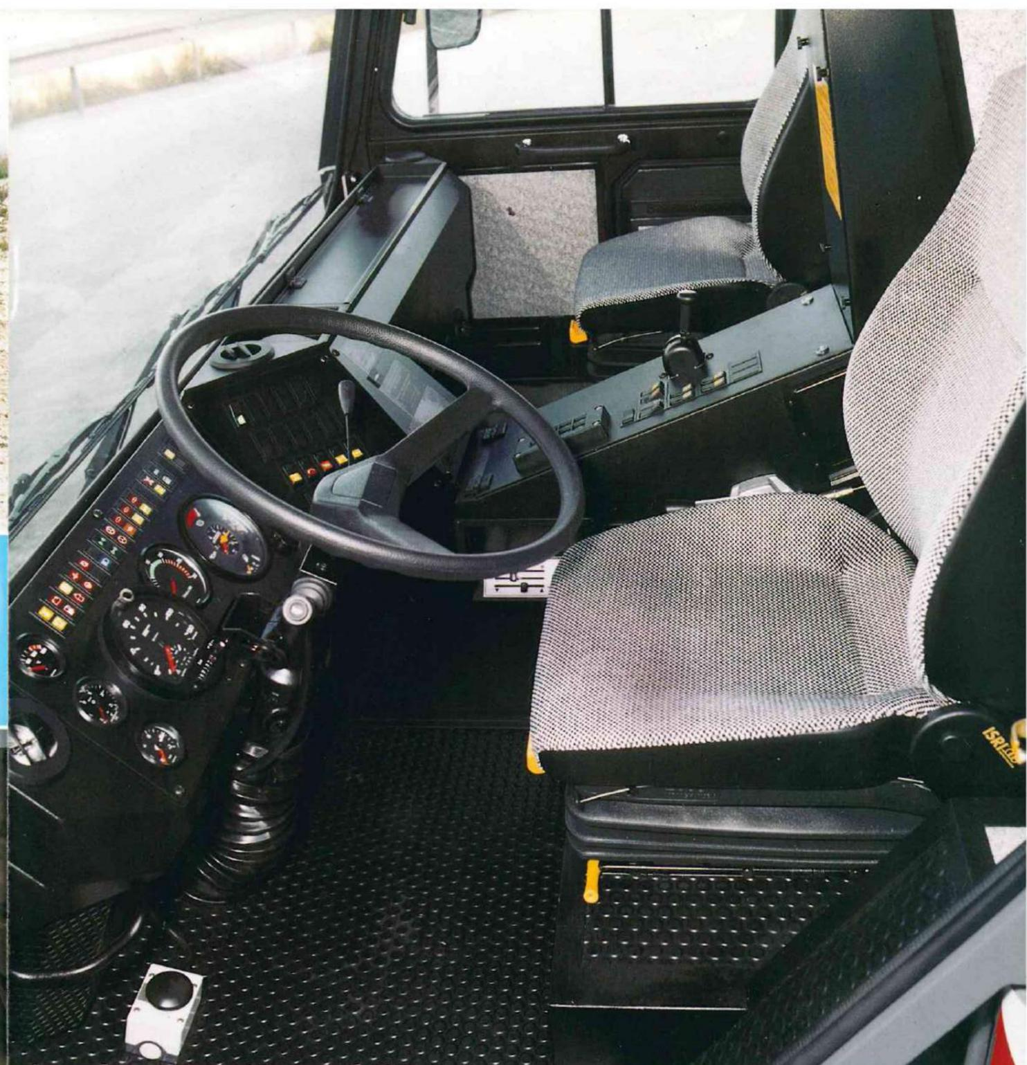
Liebherr-Fahrerhäuser sind verzinkt, korrosionsbeständig und schallgedämmt und bieten viel Platz für Fahrer und Beifahrer, weil der Fahrmotor außerhalb der Kabine im Fahrzeugrahmen gelagert ist. Gefederter, vielfach verstellbarer Fahrersitz mit pneumatischer Lendenwirbelstütze, in der Höhe und Neigung verstellbares Lenkrad, beheizte Außenspiegel sowie mit Standardsymbolen versehene Bedienungs- und Kontrollinstru-
