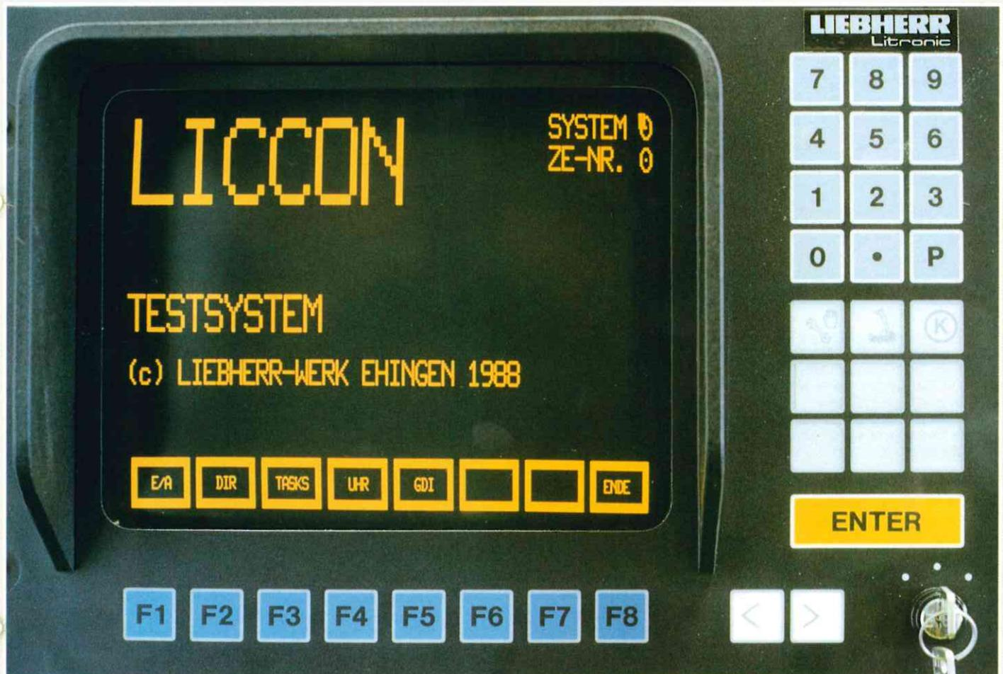
Das Testsystem für Mobilkrane ist ein Baustein der Litronic, die ein Gesamtsystem aus intelligenter Elektronik und funktioneller Hydraulik darstellt.
