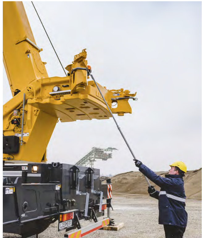
Der Radius der Ballastierzylinder wird einfach und schnell verstellt
