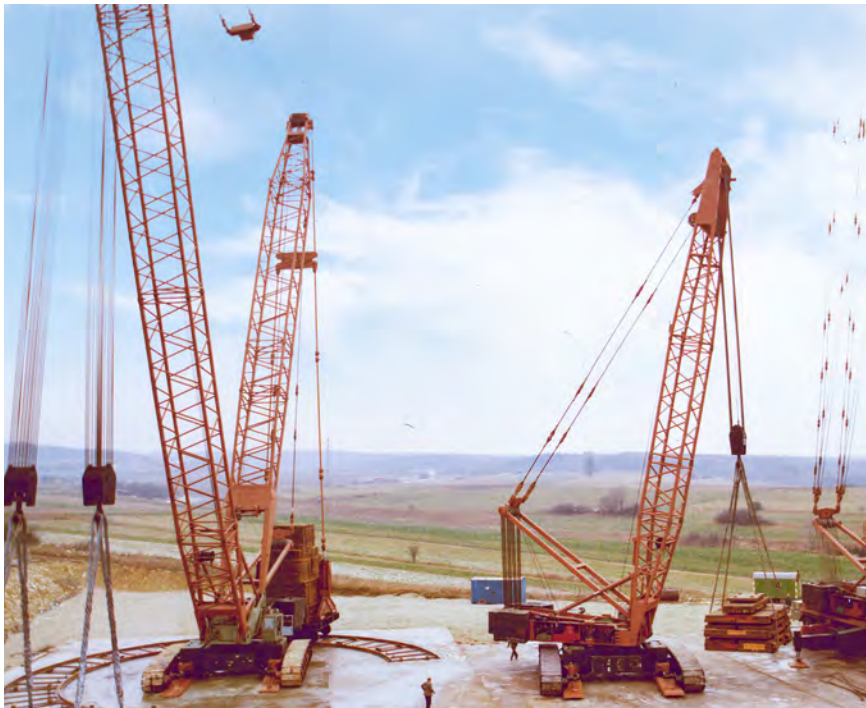
1977 auf dem Testgelände bei Liebherr in Ehingen: LR 1300 mit und ohne Derricksystem.
