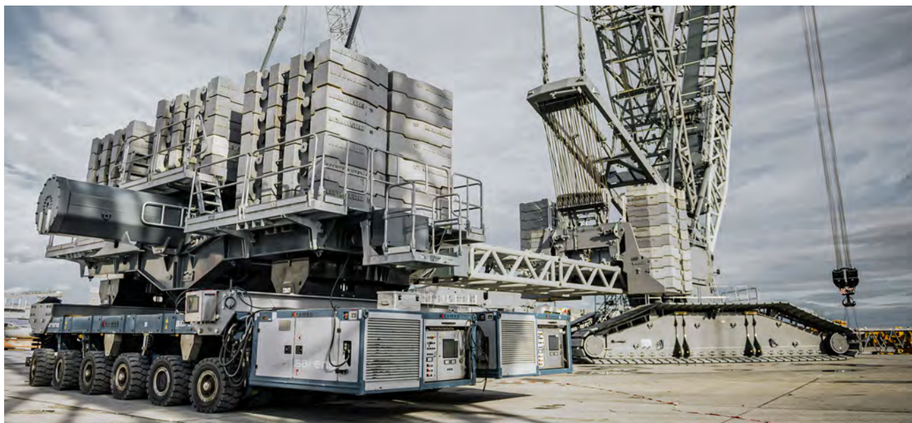
Die Zukunft: Ein Ballastwagen mit SPMT als Unterwagen.
