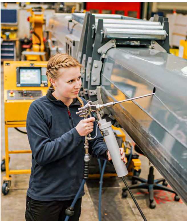
Mit der Fettsprühstange kann der Teleskopausleger sowohl innen als auch außen gefettet werden.
