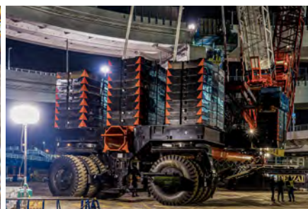
Moderne Ballastwagen für Kreis-, Schlepp- und Parallelfahrt.
