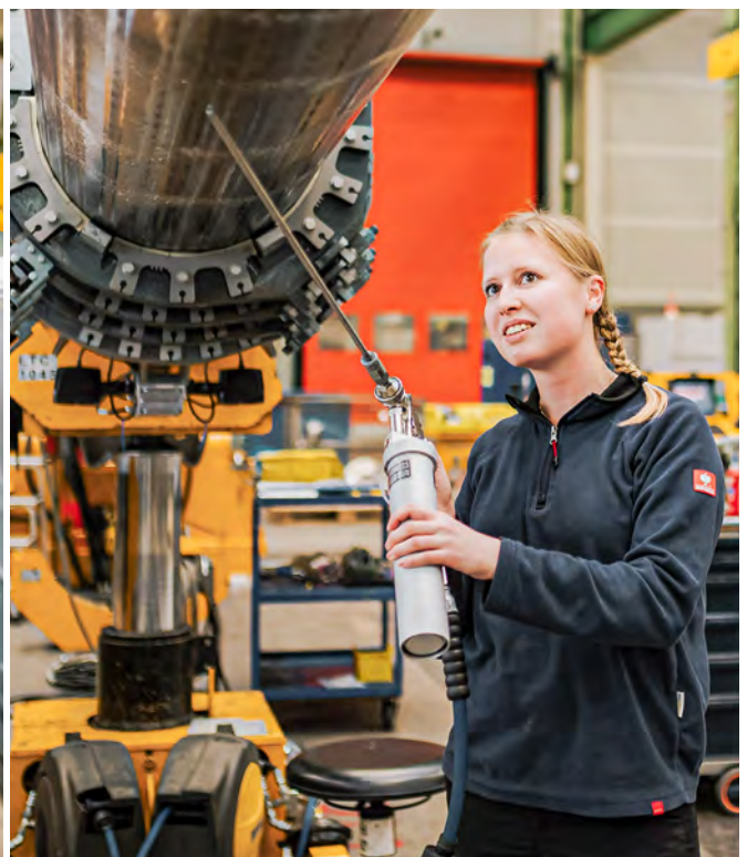
Mit der Fettsprühstange kann der Teleskopausleger sowohl innen als auch außen gefettet werden.
