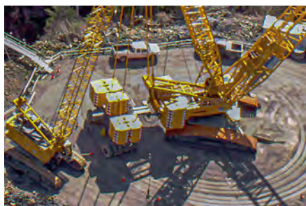
Moderne Ballastwagen für Kreis-, Schlepp- und Parallelfahrt.
