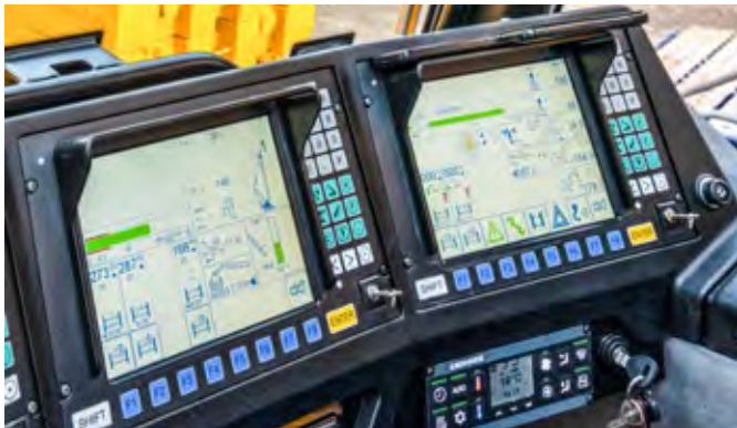
Alle Parameter von Kranzustand und Hebevorgang melden die Systeme ins Fahrerhaus des LR 1700-1.0. Das rechte Display weist einen aktuellen Lastfall von 86 Tonnen aus.
