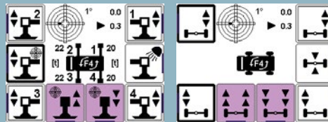
Abstützen mit vollautomatischem Nivellieren
