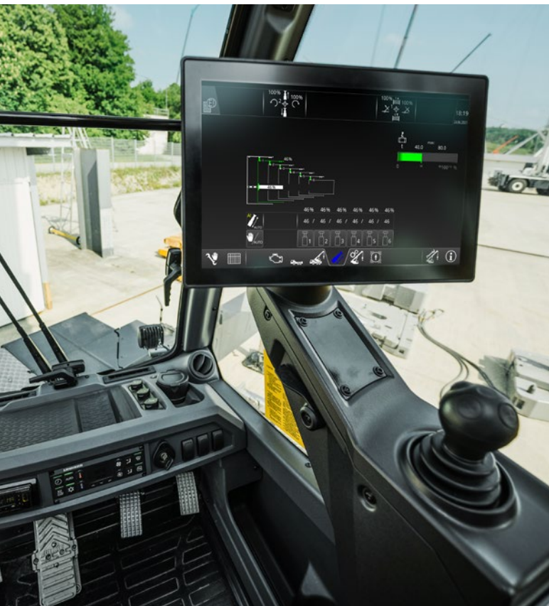
Display mit Touch-Funktion in der Oberwagenkabine für intuitive und komfortable Bedienung
