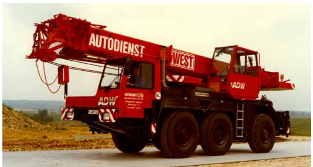
Prototyp 1988 LTM 1035 mit LICCON-Steuerung
