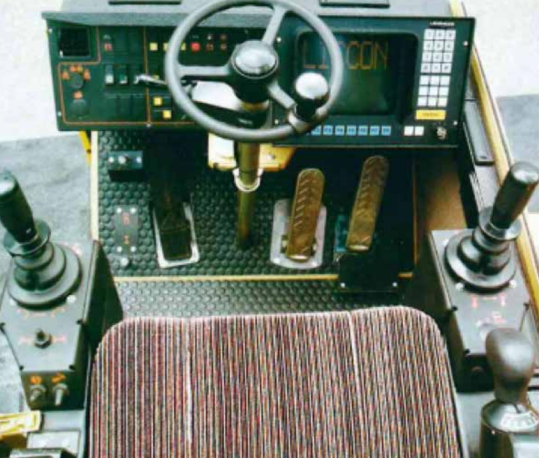
Erste LICCON-Steuerung mit Röhren-Monitor
