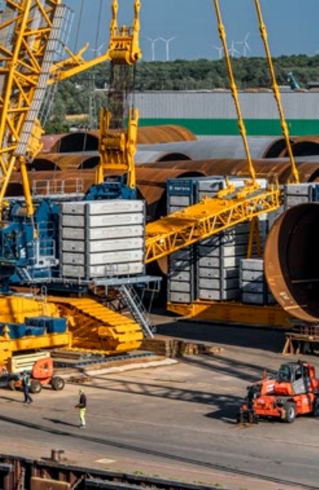
Die innovativ konstruierte Drehbühne des LR 12500-1.0 mit dem siebeneinhalb Meter breiten HighPerformanceBoom
