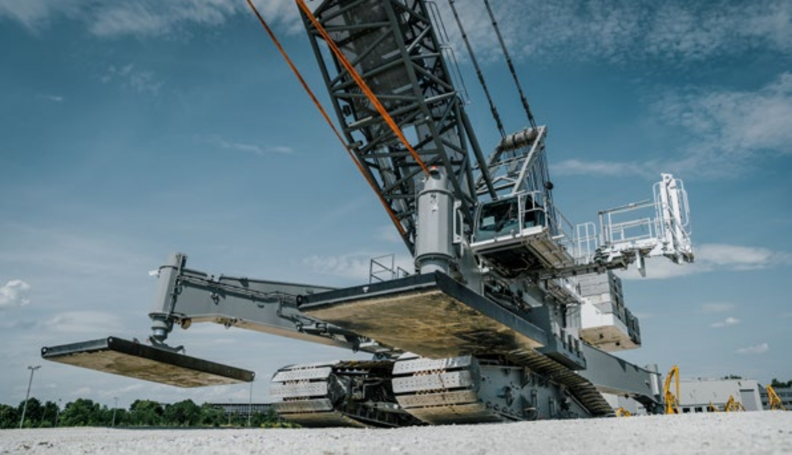
Das Fahrwerk des LR 1700-1.0W ist lediglich 5,9 Meter breit.
