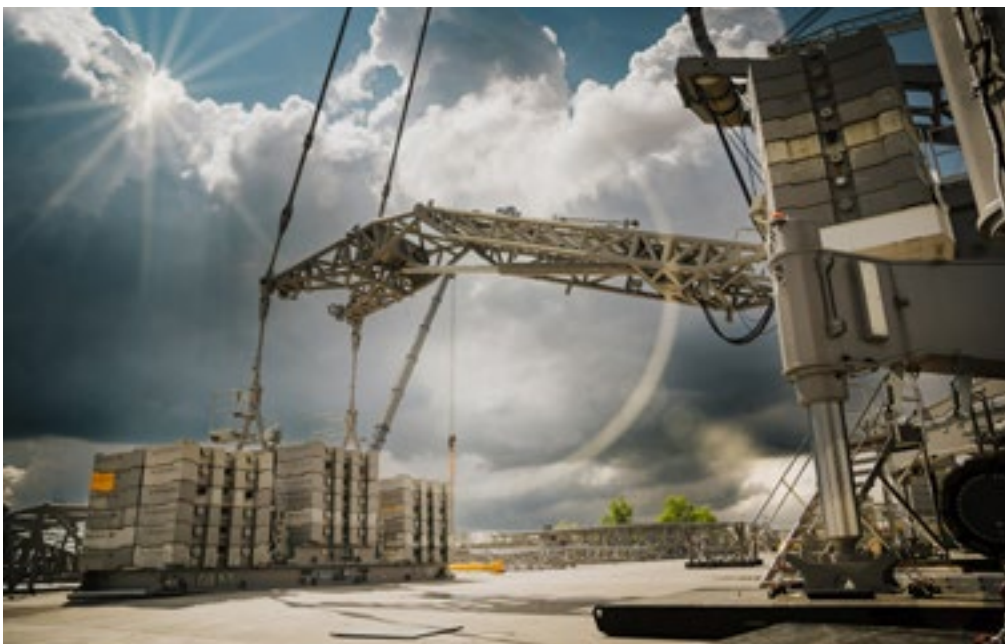
Auch bei der Schmalspur-Version kommt die hydraulisch verstellbare Ballastführung V-Frame® zum Einsatz.
