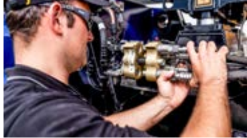
Die Hydraulik wird über Schnellkupplungen verbunden.
